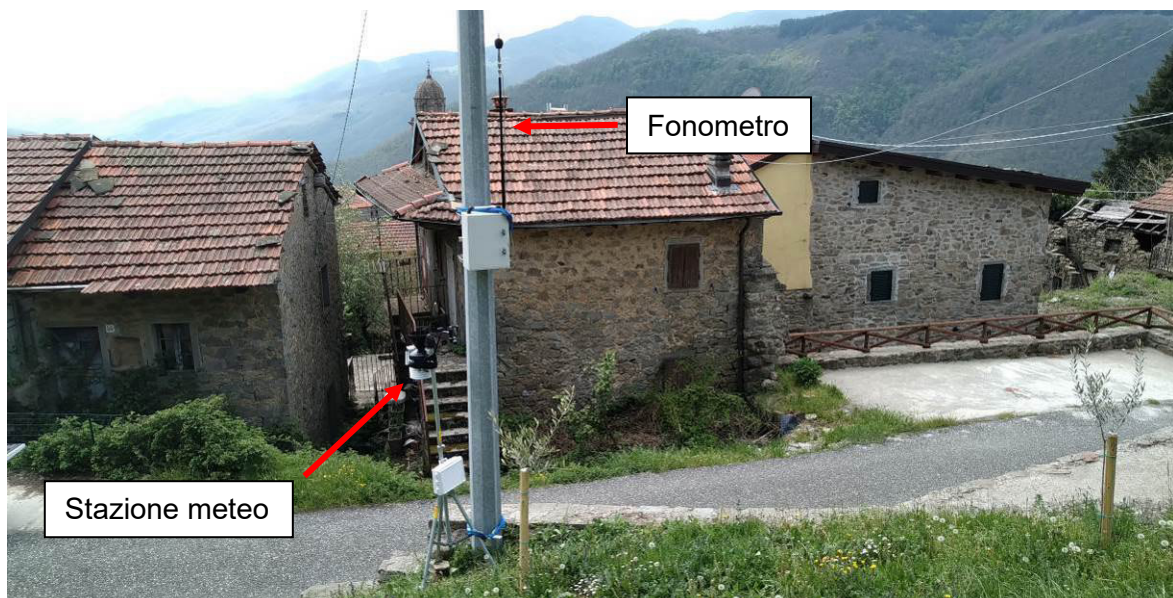
Figura 9.13 - Postazione P4 Bratto - Punto di installazione fonometro e stazione meteo
