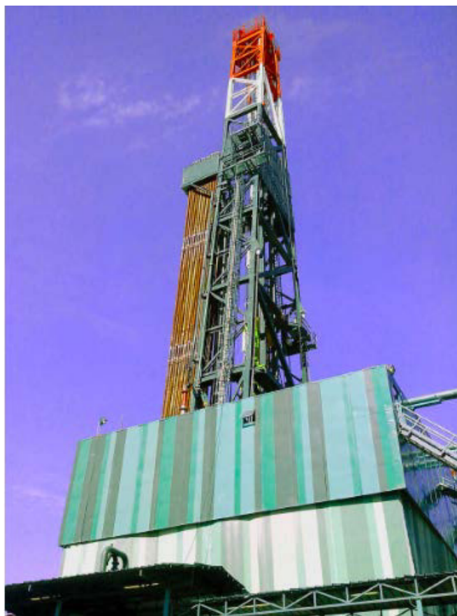
Figura 51. Impianto perforazione tipo DRILLMEC MAS8000 (fonte: sito PERGEMINE)
