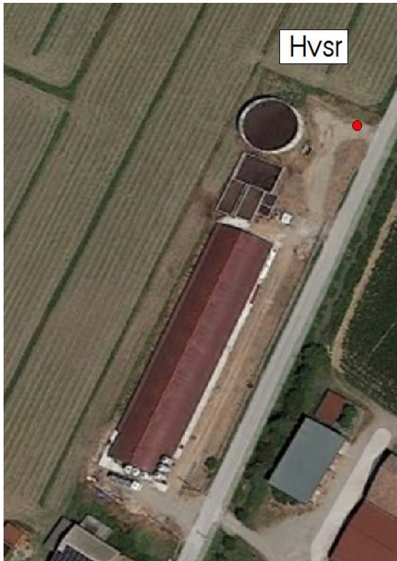
Planimetria con ubicazione sondaggi geognostici eseguiti in sito: Hvsr: indagine sismica passiva.
