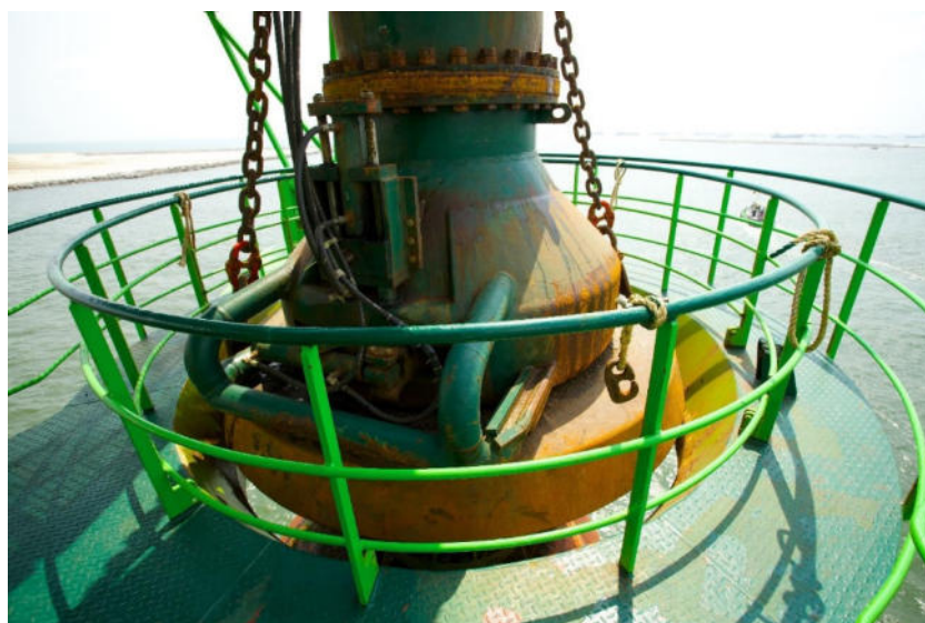
Figura 9 – Connessione della TSHD alla tubatura galleggiante (bow coupling/collegamento di prua).
