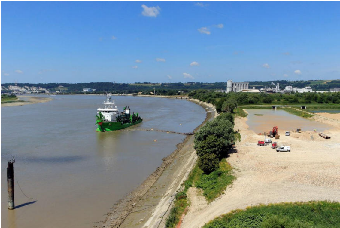
Figura 11 – Dopo la connessione/bow coupling. Inizio refluito/pompaggio.
