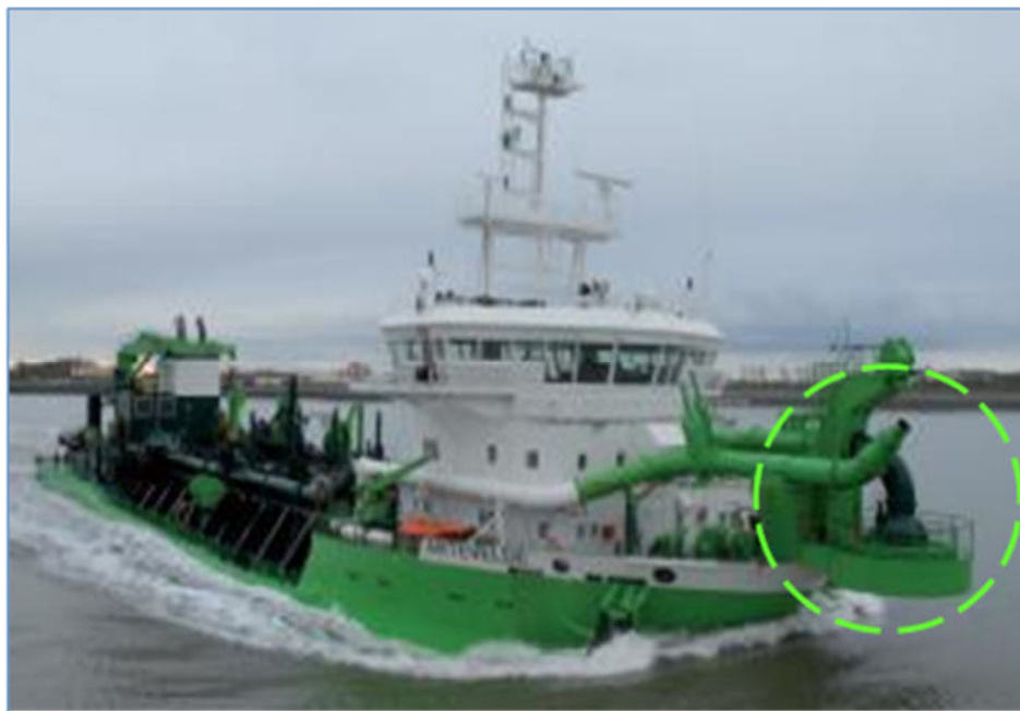
Figura 3 – Draga autocaricante – Linea di refluento fissa di prua
