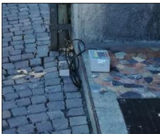
Figura 4-32 – Posizionamento attrezzatura per esecuzione misura vibrazioni
