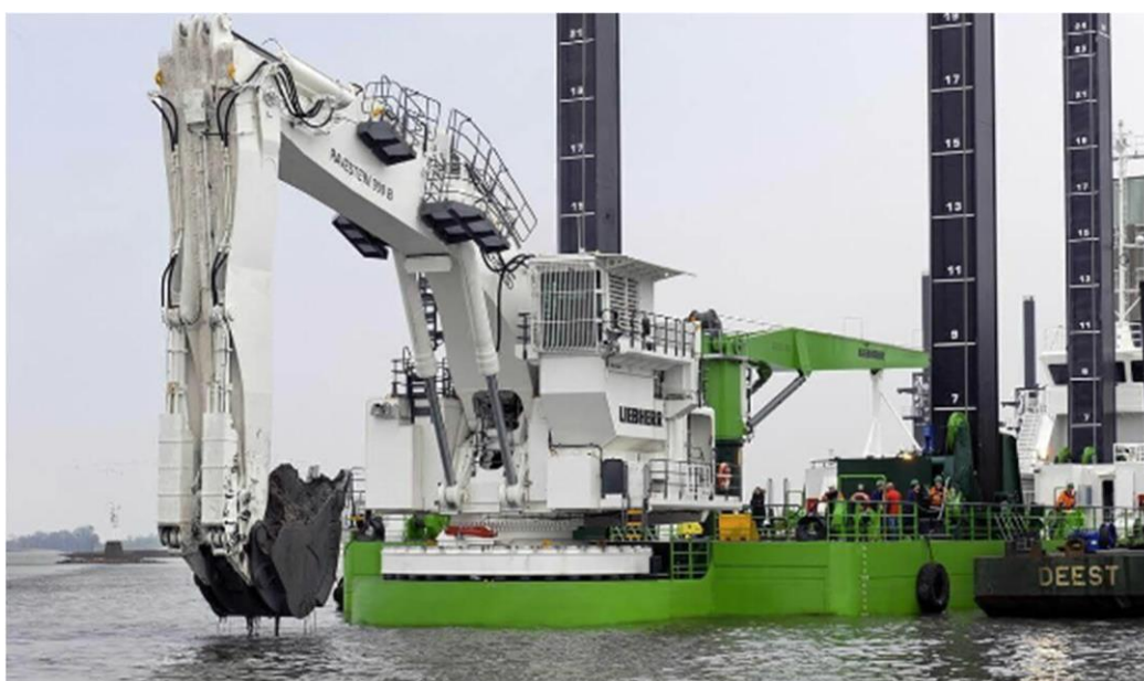
Figura 1-7 Immagine di backhoe dredger
