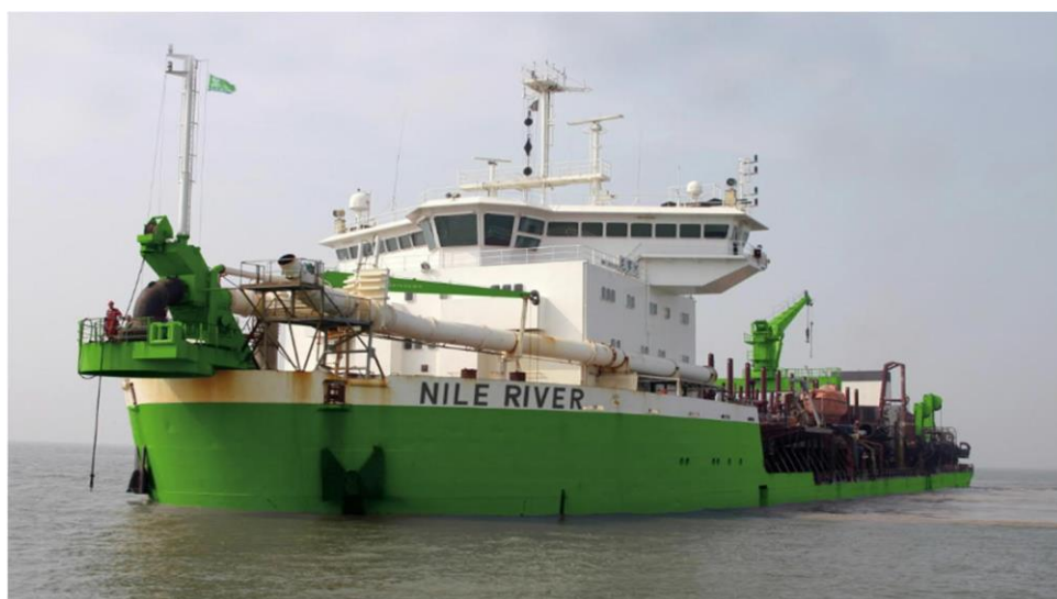
Figura 1-3 Immagine di draga aspirante
