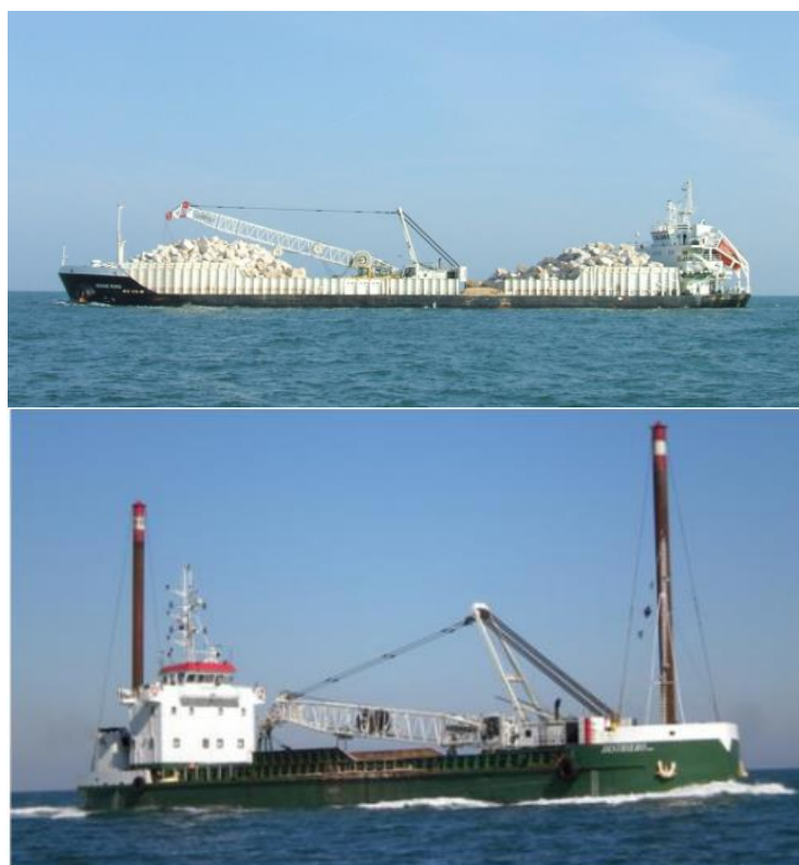
Figura 3.2.F2 - Tipici di bette (motonavi) utilizzabili nelle attività di realizzazione della diga frangiflutti
