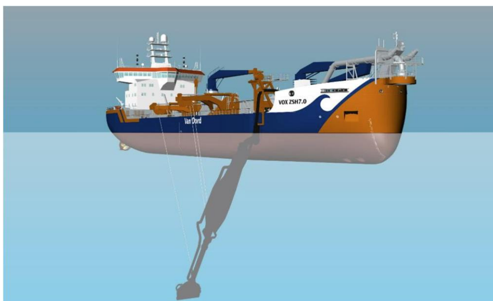
Figura 1-2 Esempio di draga aspirante
