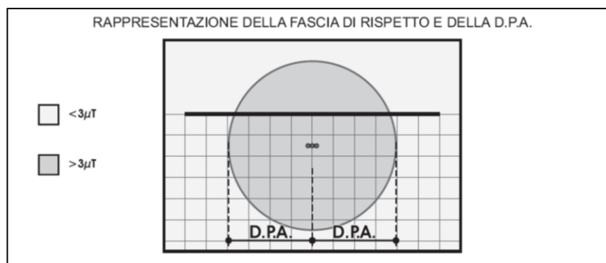
Figura 2.2: Fasce di rispetto e Distanza di Prima Approssimazione per Elettrodotti Interrati
