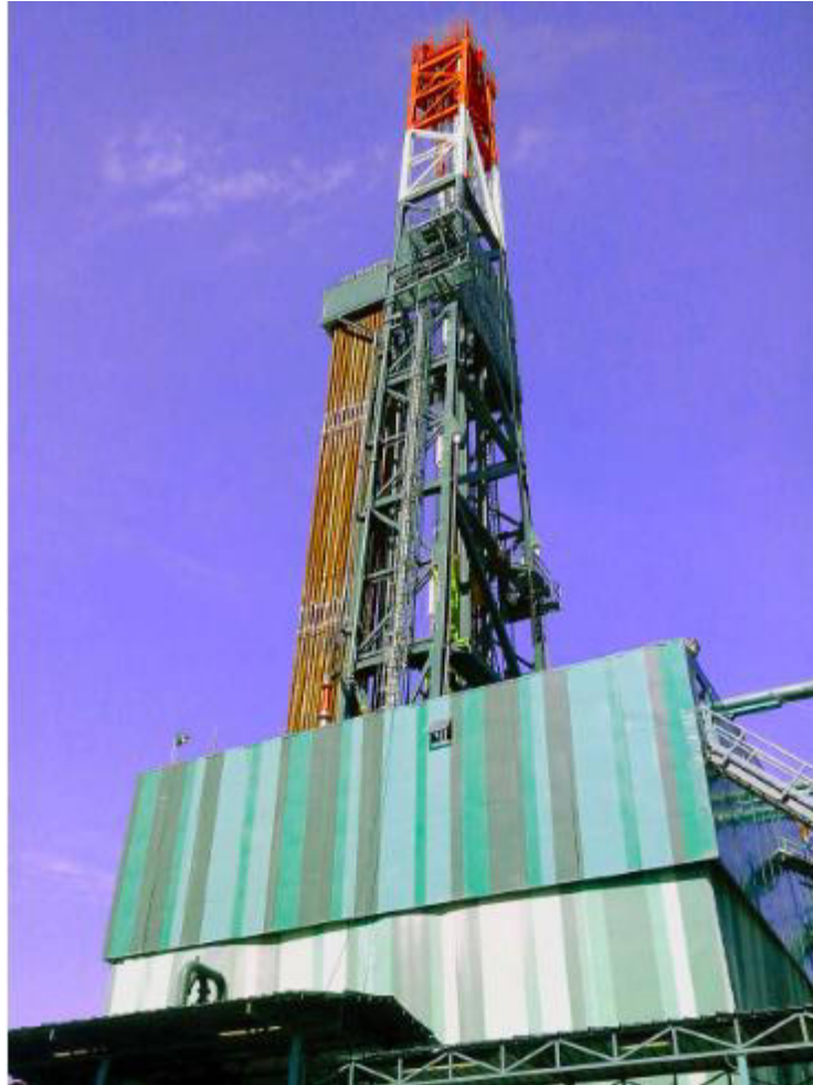
Figura 6. Impianto di perforazione tipo DRILLMEC MAS8000. Fonte: Pergemine
