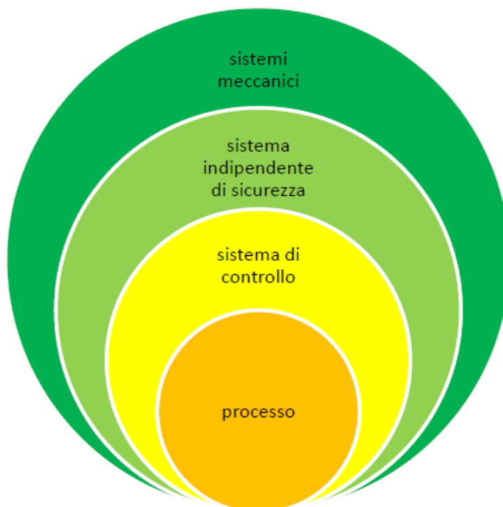
Figura 3 – Livelli indipendenti di protezione per la sicurezza funzionale
