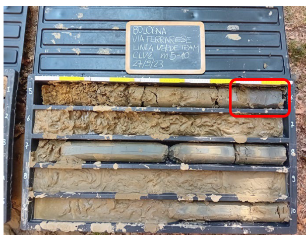
Figure 12: dettaglio fotografico LV 2 m 5-10 ipotetico paleosuolo tra m 5.90-6.00 di profondità
