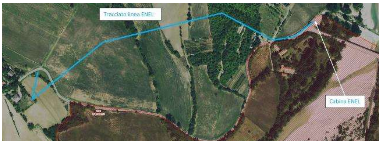
Figura 3: Inquadramento Indicazione del tracciato della linea elettrica di connessione e della cabina in riferimento ai confini della ZSC IT 40300013 potenzialmente coinvolta. fonte: viewer regionale MinERva
