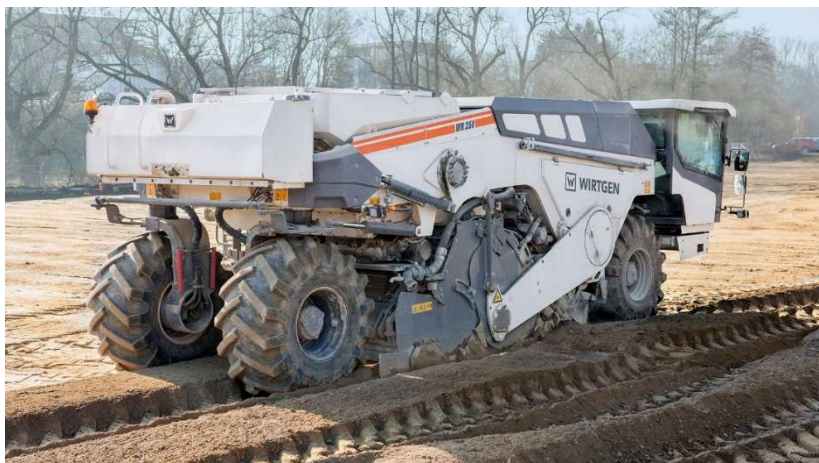
Figura 9 – Macchina spandilegante-miscelatrice
