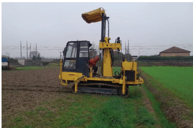
Figura 5-2 - Mezzo utilizzato per le prove CPTU
