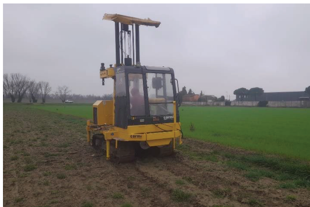
Figura 5-2 - Mezzo utilizzato per le prove CPTU
