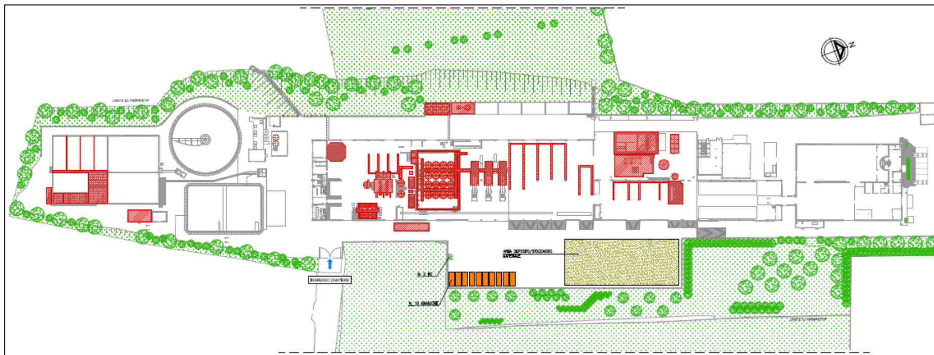
Figura 21 – Planimetria area di cantiere durante la fase di cantiere numero 3 (Realizzazione delle opere civili di preparazione del sito) [Fonte: stralcio elaborato PD A.3]
