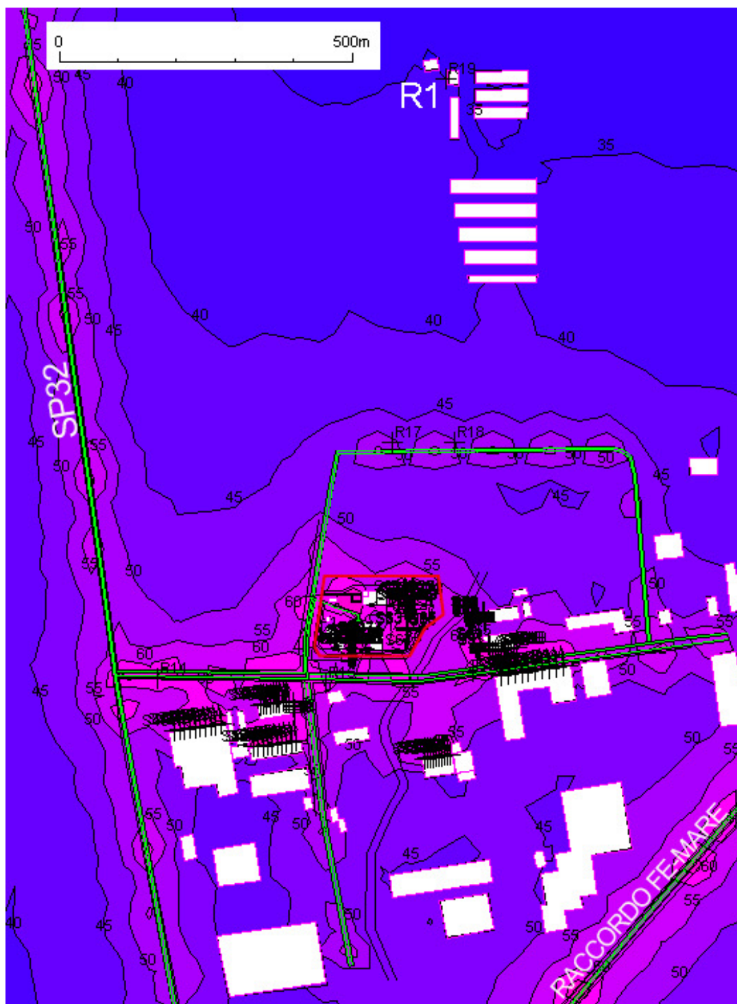
Fig.5 Mappatura isofonica (h.3 m) a grande scala della situazione post operam diurna
