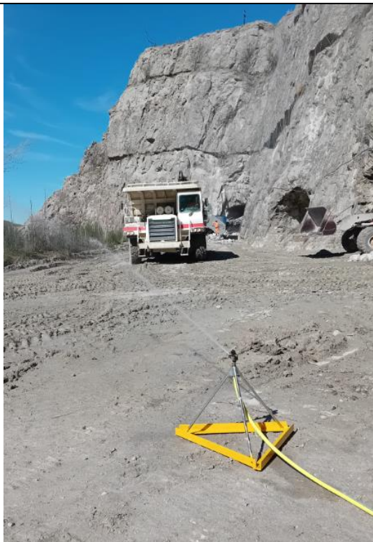
Fig. 7 – Bagnatura per mezzo di spruzzatori girevoli
