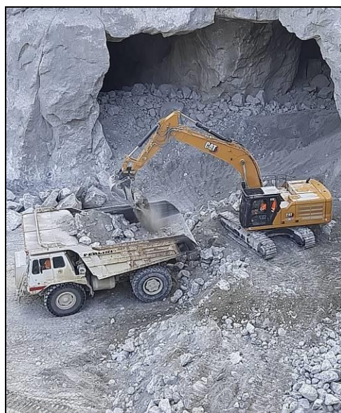
Fig. 17 – Fase di scarico del materiale con pala all'interno del frantoio mobile (sinistra); fase di carico della pietra con escavatore all'interno del dumper.
