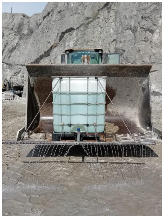
Fig. 5 – Cisterna con barra erogatrice installata sulla benna della pala per irrigazione
