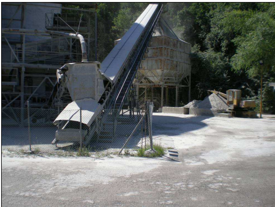
Fig. 9 - Nastri e silos coperti da tettoie.
