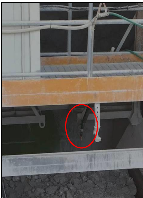
Fig. 16 – particolare del sistema di nebulizzazione materiale frantumatore Bedeschi.
