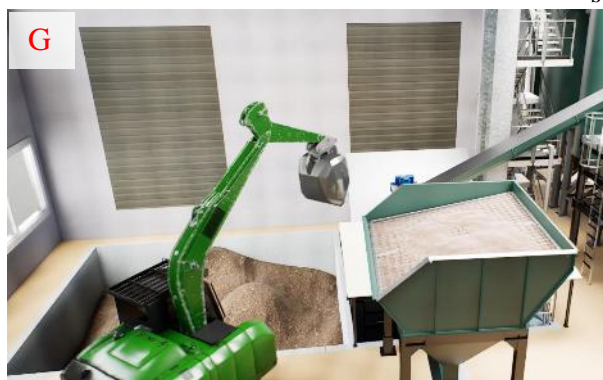
Fig. 2.8.3 – Inizio lavorazioni con carico fango su tramoggia
