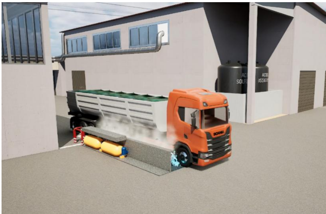
Fig. 2.8.10 – Particolare impianto lavaruote
