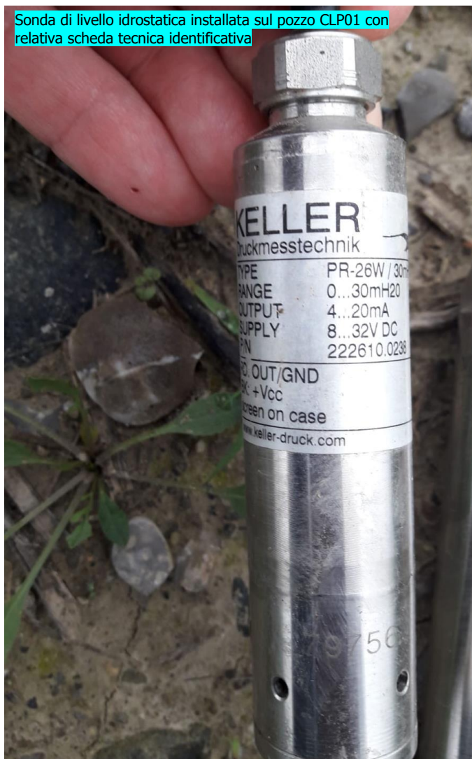
Foto 23 – Sonda di livello idrostatica installata sul pozzo CLP01 con relative specifiche tecniche.
