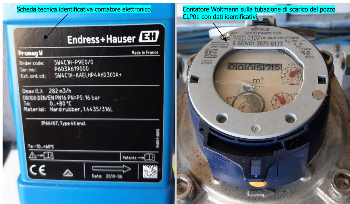
Foto 19 e 20 – Scheda tecnica identificativa sul contatore elettronico verso la rete e contatore Woltmann con dati identificativi e specifiche tecniche sulla tubazione di scarico del pozzo CLP01.
