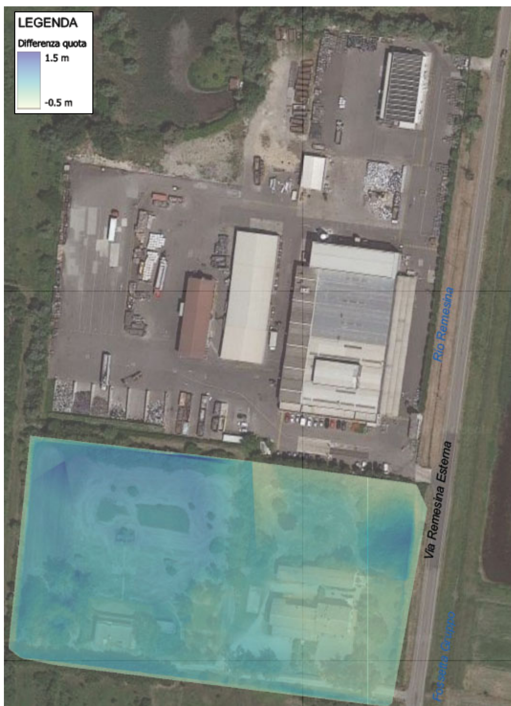
Figura 24 – confronto DTM stato di fatto e stato di progetto dell'area indagata.
