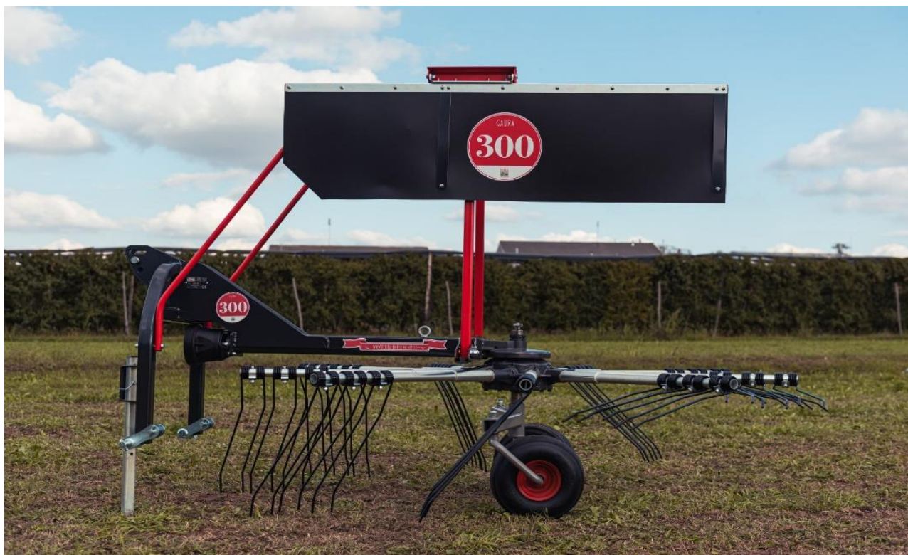
Figura 51. Andanatore a rotore unico di diametro 2,90 metri, 9 bracci e 5 denti
