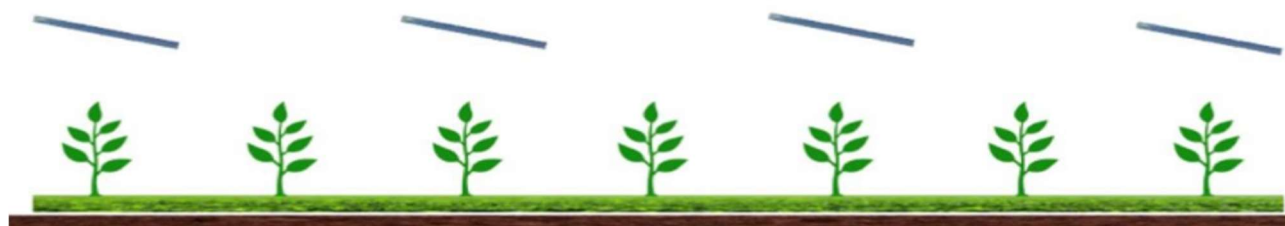
Figura 3: Sistema agrivoltaico in cui la coltivazione avviene tra le file dei moduli fotovoltaici, e sotto a essi (TIPO 1).
