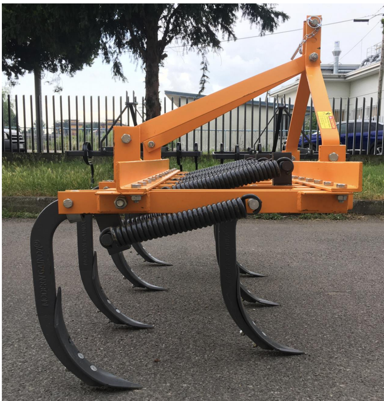
Figura 45. Ripuntatore/Estirpatore a 7 ancora o denti fissi
