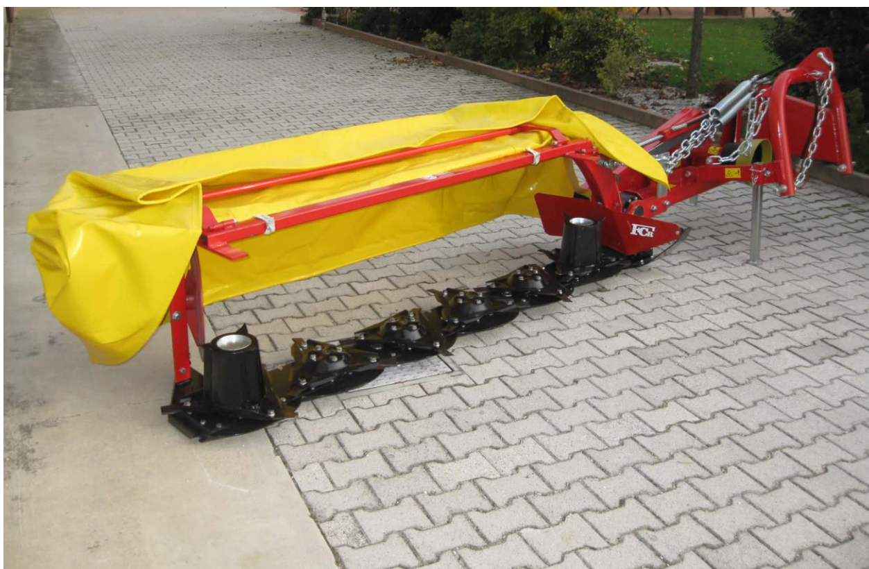
Figura 50. Falciatrice rotativa a dischi con larghezza di lavoro di circa 2,50 metri
