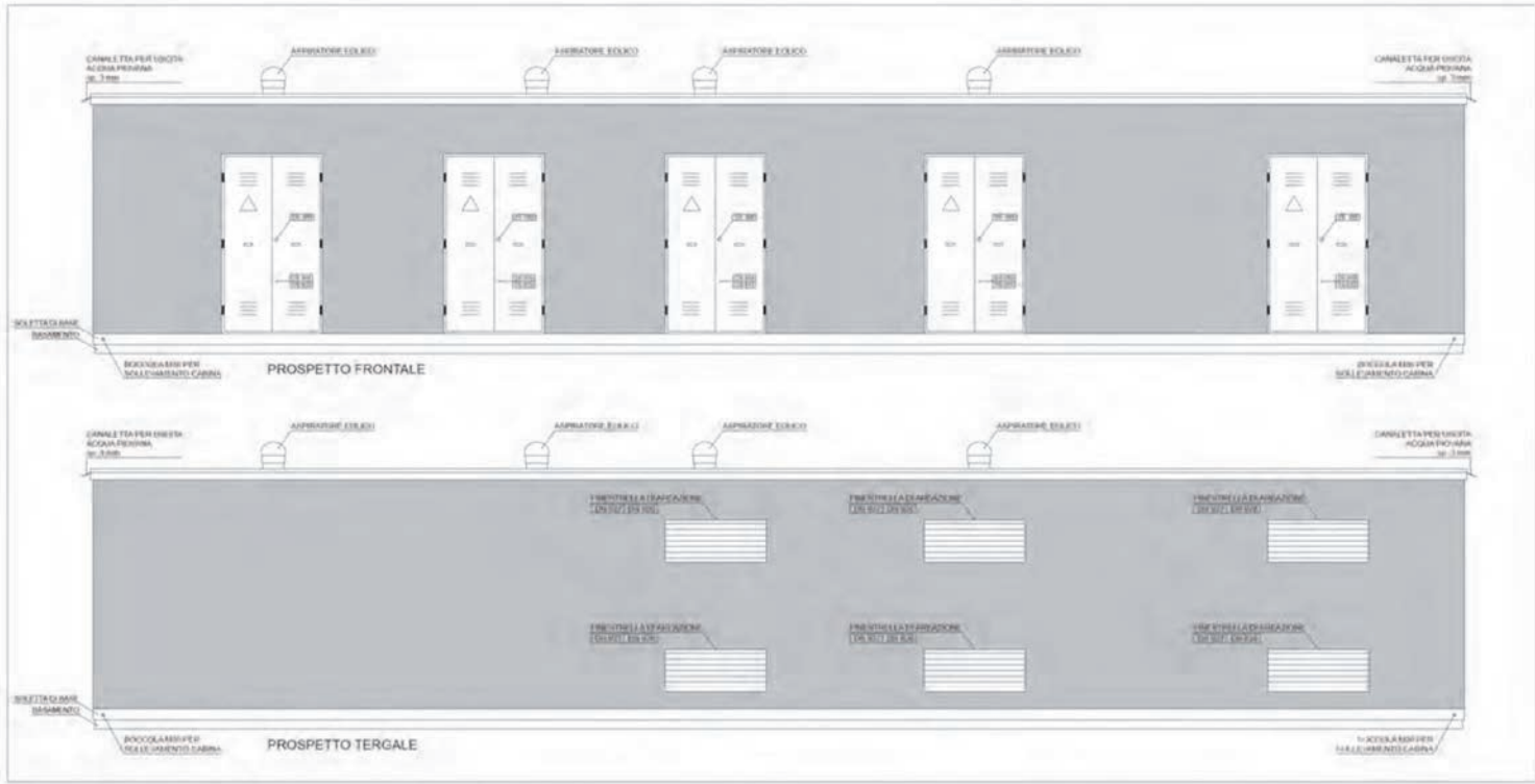
PROSPETTI FRONTALI E TERGALE CABINA DI INTERFACCIA
