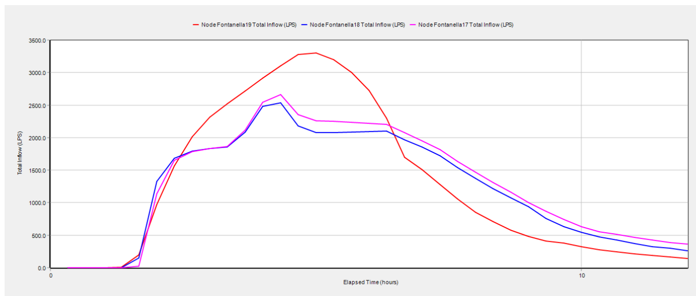
Figura 11 - - Idrogrammi di piena nel cavo Fontanella Sezione 19 a monte dello sfioro, sezione 18 a valle dello sfioro, sezione 17 a valle dello scarico
