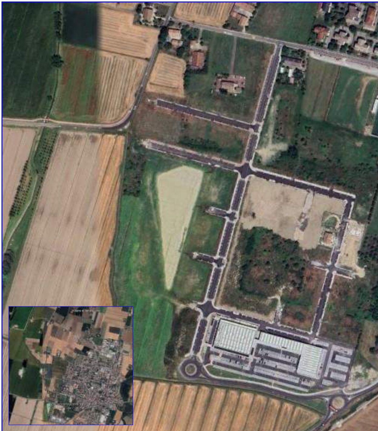
Figura 23 Vasca di laminazione temporanea al servizio del comparto, oggetto di dismissione con ritombamento
