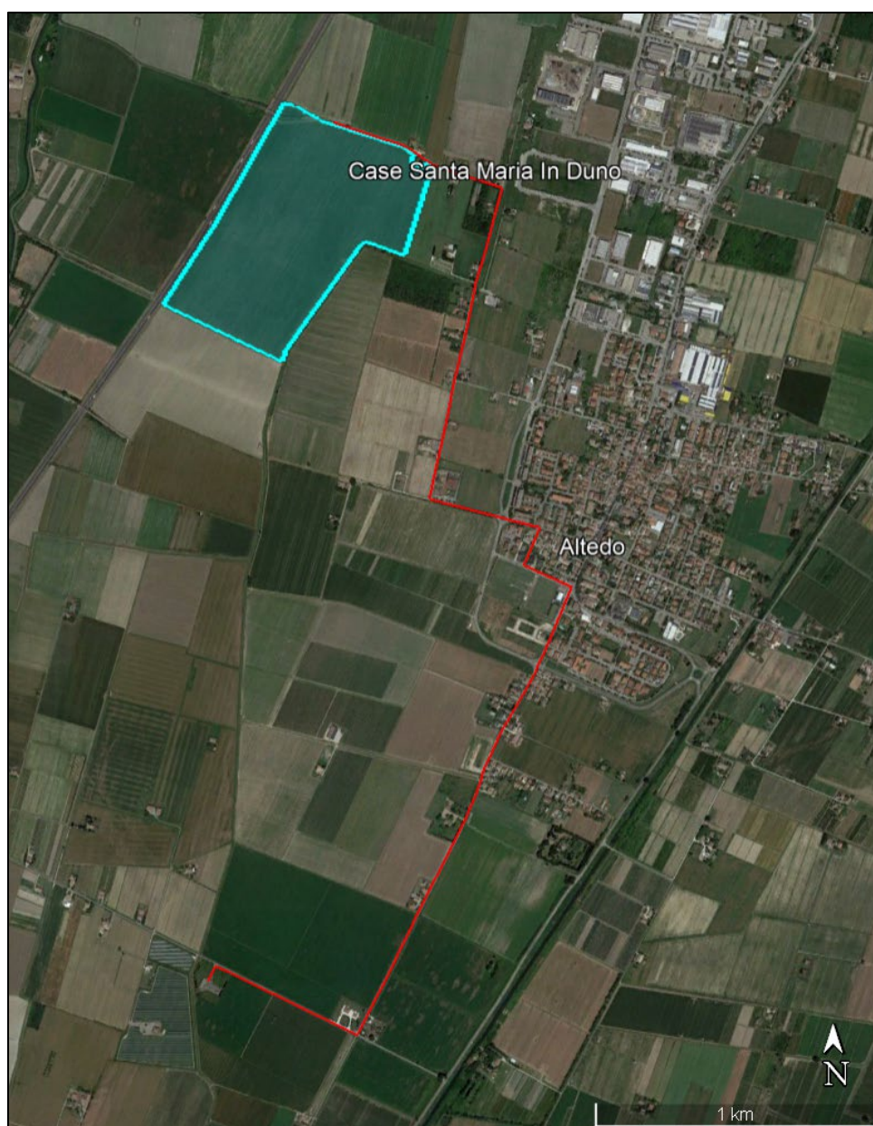
Figura 1 – Planimetria di progetto su ortofoto Google Earth: in azzurro l'area dell'impianto fotovoltaico, in rosso lo sviluppo del cavidotto MT
