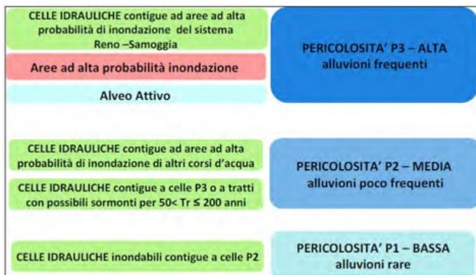
Figura 52: Schema di utilizzo delle perimetrazioni contenute nella pianificazione di bacino e della perimetrazione regionale delle celle idrauliche nelle mappe della pericolosità per la pianura
