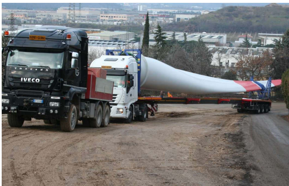
Esempio di traino durante il cantiere dell'impianto eolico Monte Mesa di AGSM
