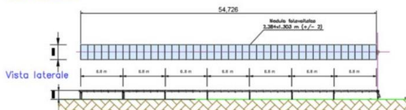
Figura 28 –tracker singolo 42 moduli
