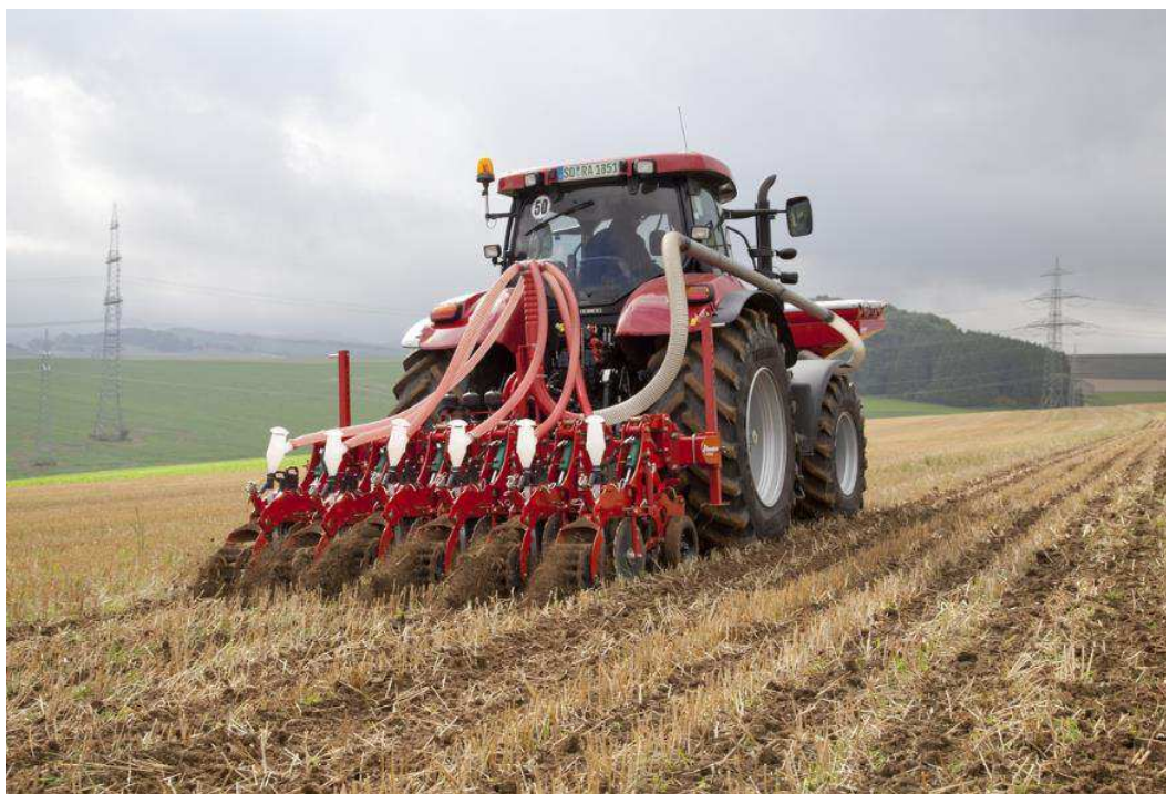
Figura 30: Semiatrice su sodo con strip-tillage
