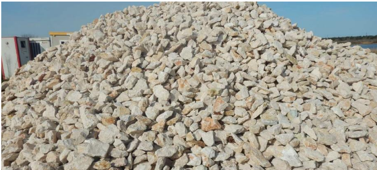
Figura 3.6 Materiale calcareo a spigolo vivo (spaccato) dimensione 100/200 mm.
