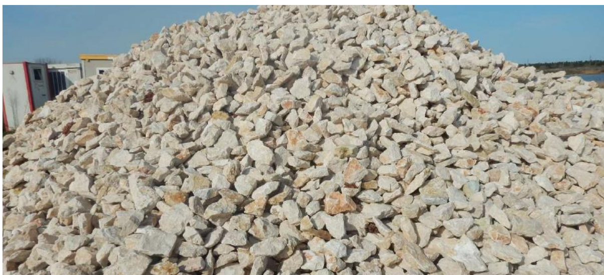
Figura 3.8 Materiale calcareo a spigolo vivo (spaccato) dimensione 100/200 mm.
