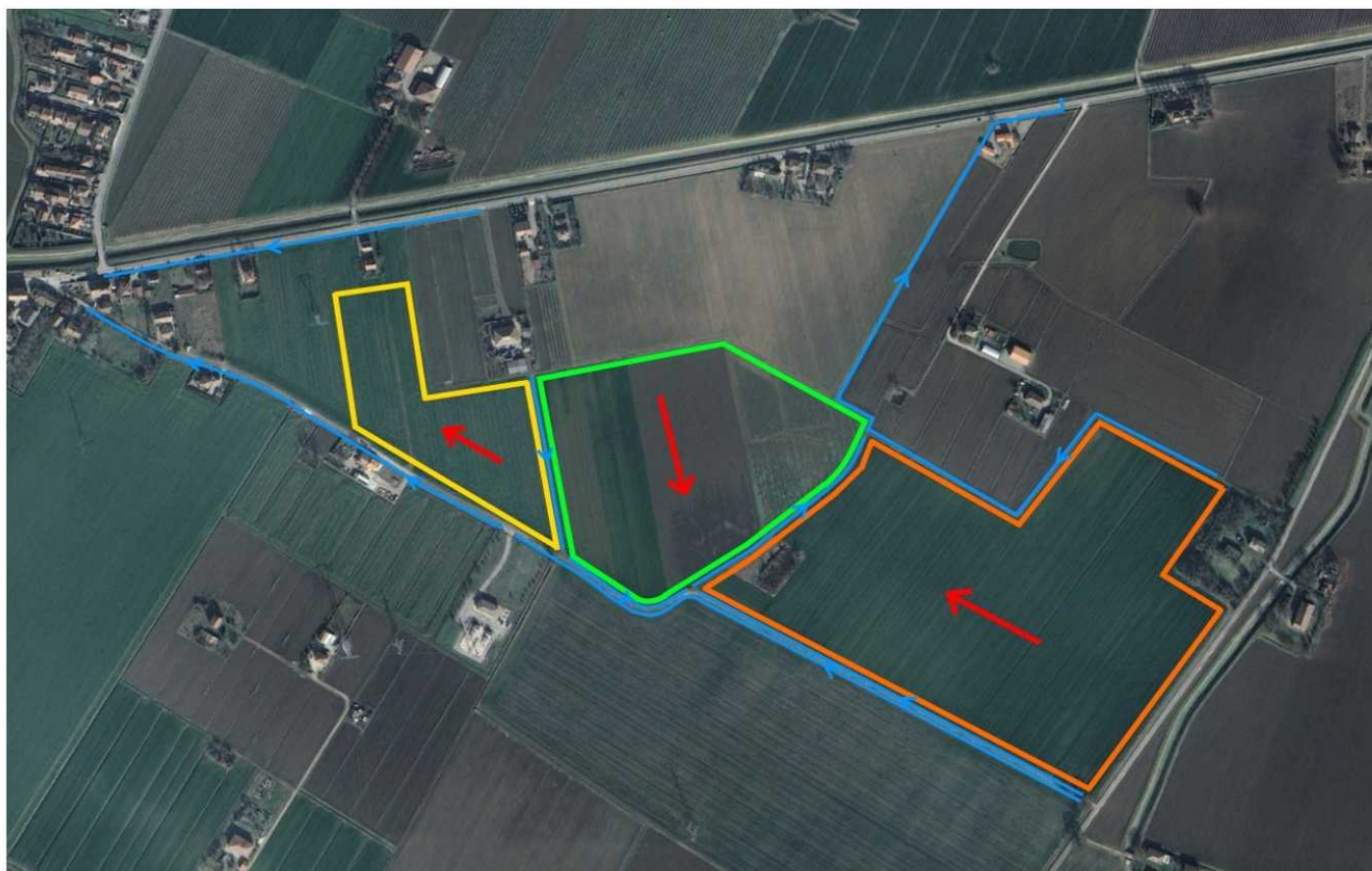
Figura 4: indicazione delle direzioni di deflusso superficiale delle aree interessate e della direzione di scolo della rete superficiale locale
