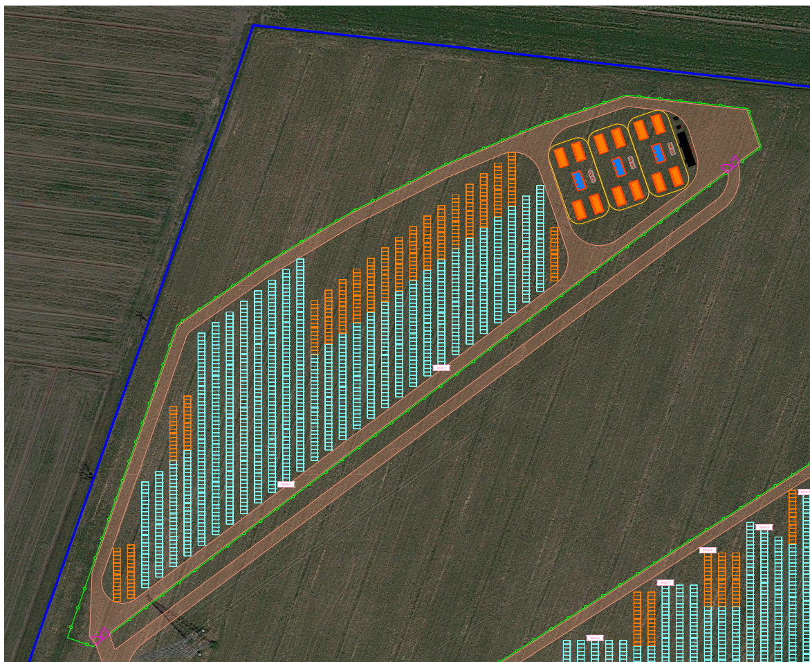
Figura 13. Layout e posizionamento sezione accumulo
