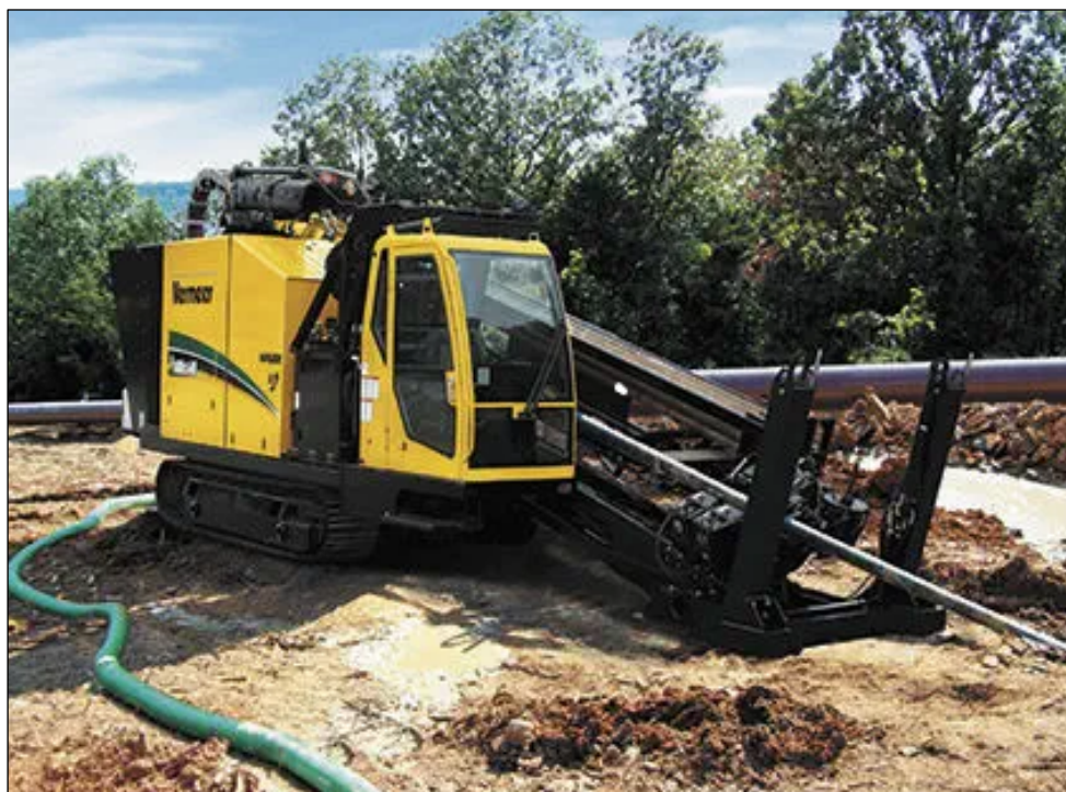
Figura 2. Esempio di macchina perforatrice per TOC
