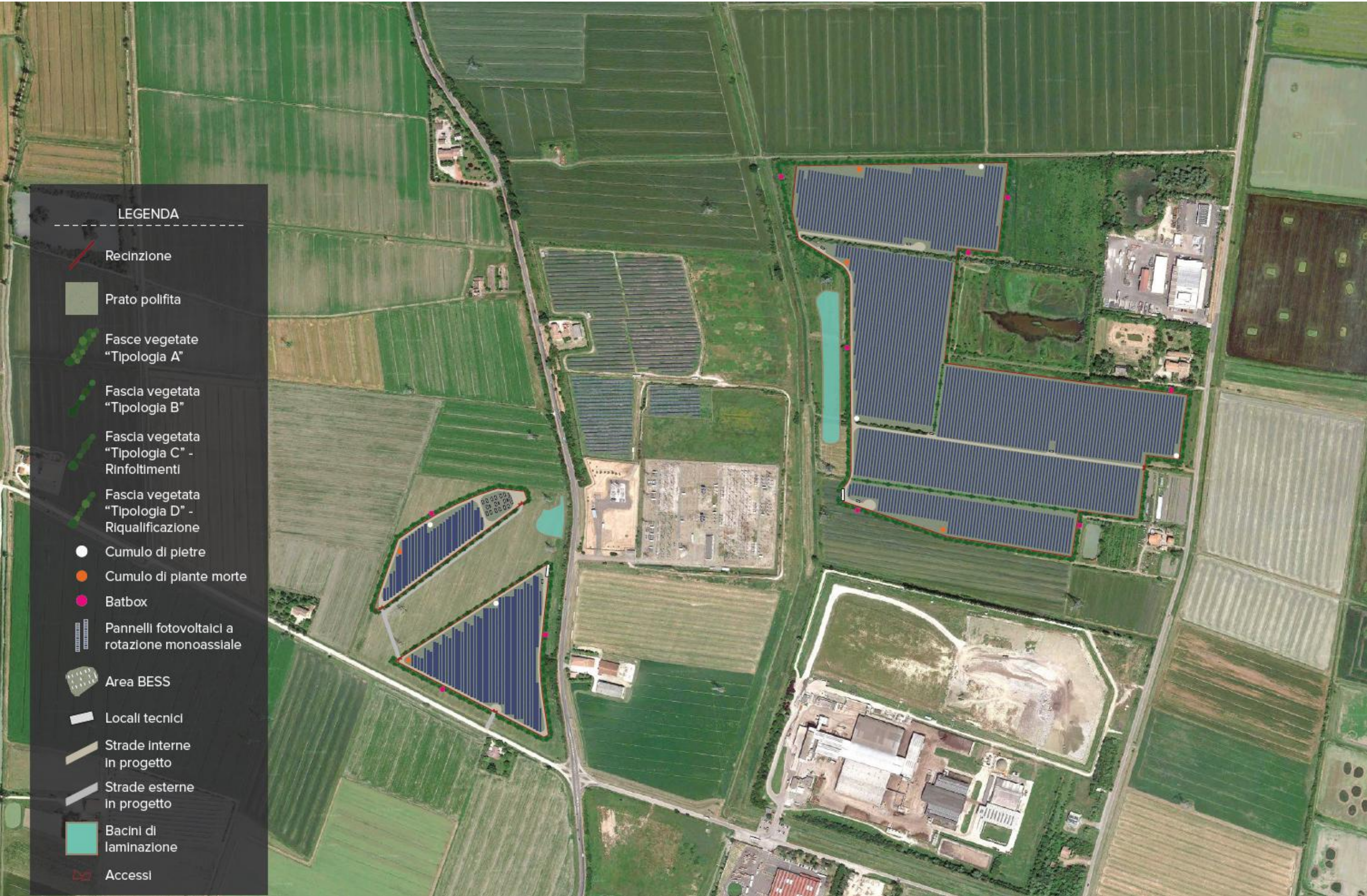
Figura 155. Layout relativo alle opere in progetto, con rappresentazione grafica della componente ambientale (prato polifita, fasce arboreo-arbustive, micro-habitat per la fauna locale) e della componente tecnologica (pannelli fotovoltaici, strade e locali tecnici) del progetto.
