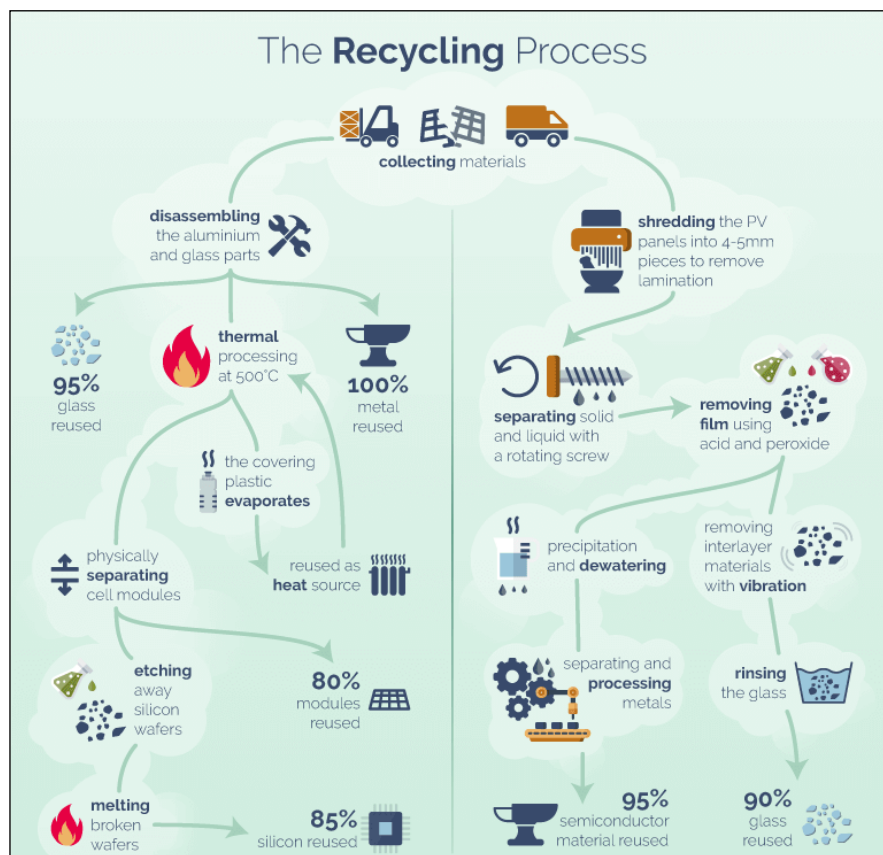
Figura 101. Il processo di riciclo dei moduli fotovoltaici a base silicea e dei sottoprodotti della dismissione di impianti fotovoltaici. Fonte: www.greenmatch.co.uk/blog/2017/10/the-opportunities-of-solar-panel-recycling (Ultimo accesso: gennaio 2024).
