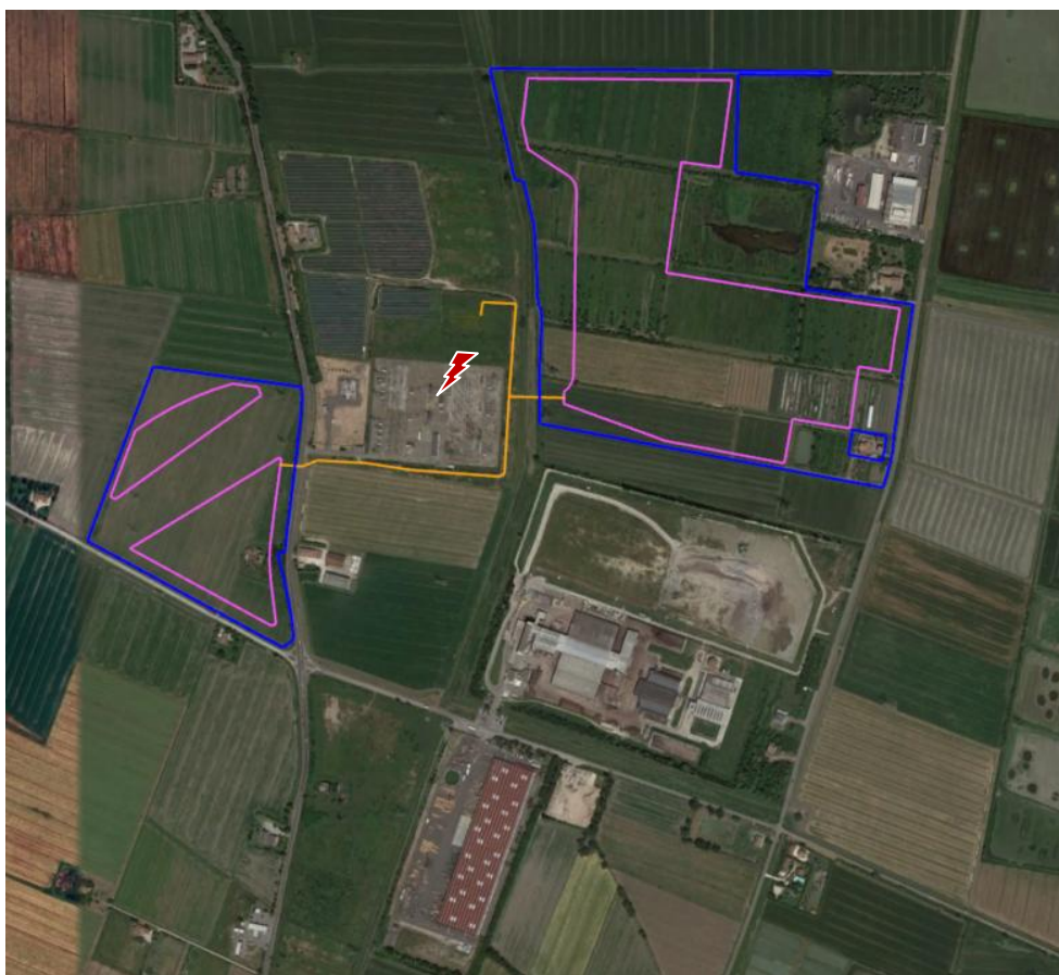
Figura 26. Localizzazione puntuale dell’area di intervento e relative opere di rete su foto satellitare: linea blu = superficie catastale; linea magenta = area di impianto; linea arancione = cavidotto di connessione; puntalino rosso = Stazione elettrica 380/132/36 kV “Carpi Fossoli” – (Fonte cartografica di base: Google Earth).
