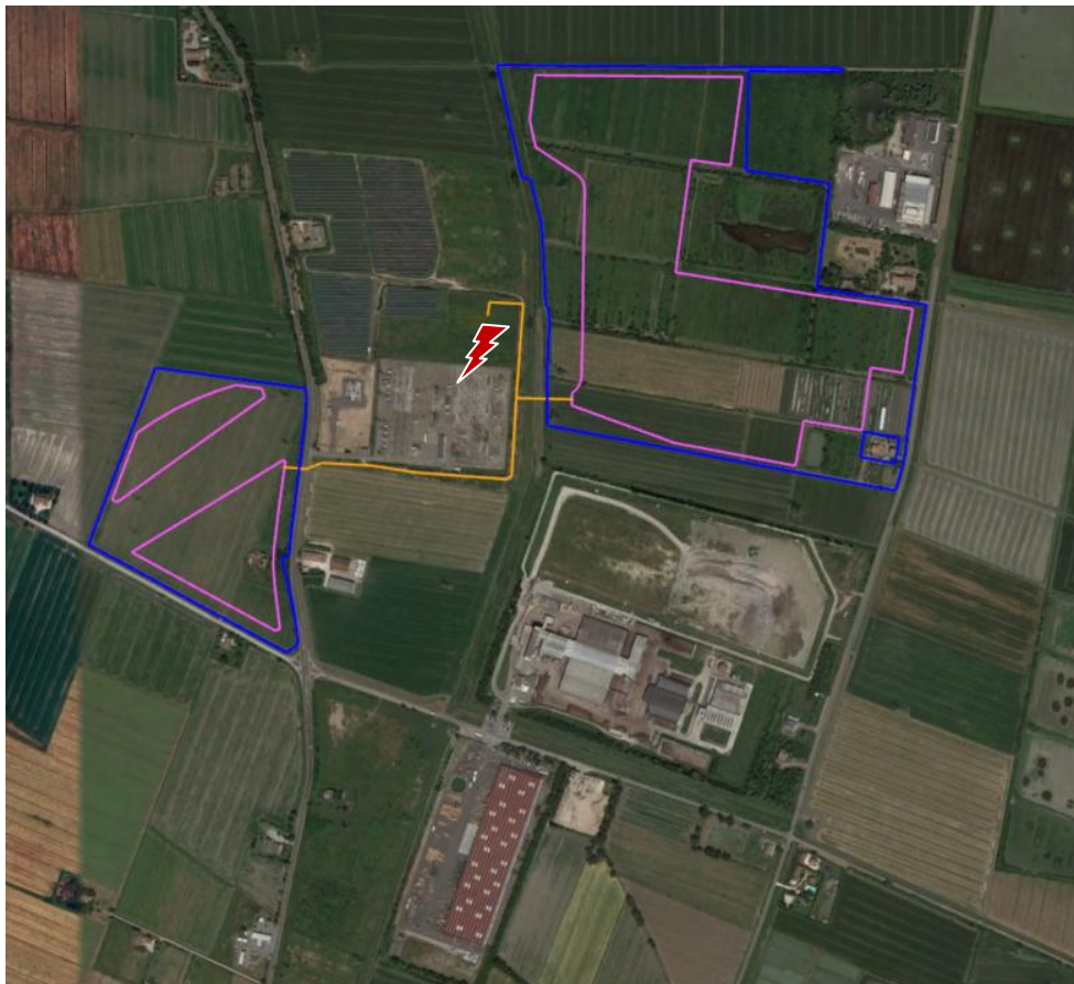
Figura 2. Localizzazione puntuale dell'area di intervento e relative opere di rete su foto satellitare: linea blu = superficie catastale; linea magenta = area di impianto; linea arancione = cavidotto di connessione; puntalino rosso = Stazione elettrica 380/132/36 kV "Carpi Fossoli" – (Fonte cartografica di base: Google Earth).
