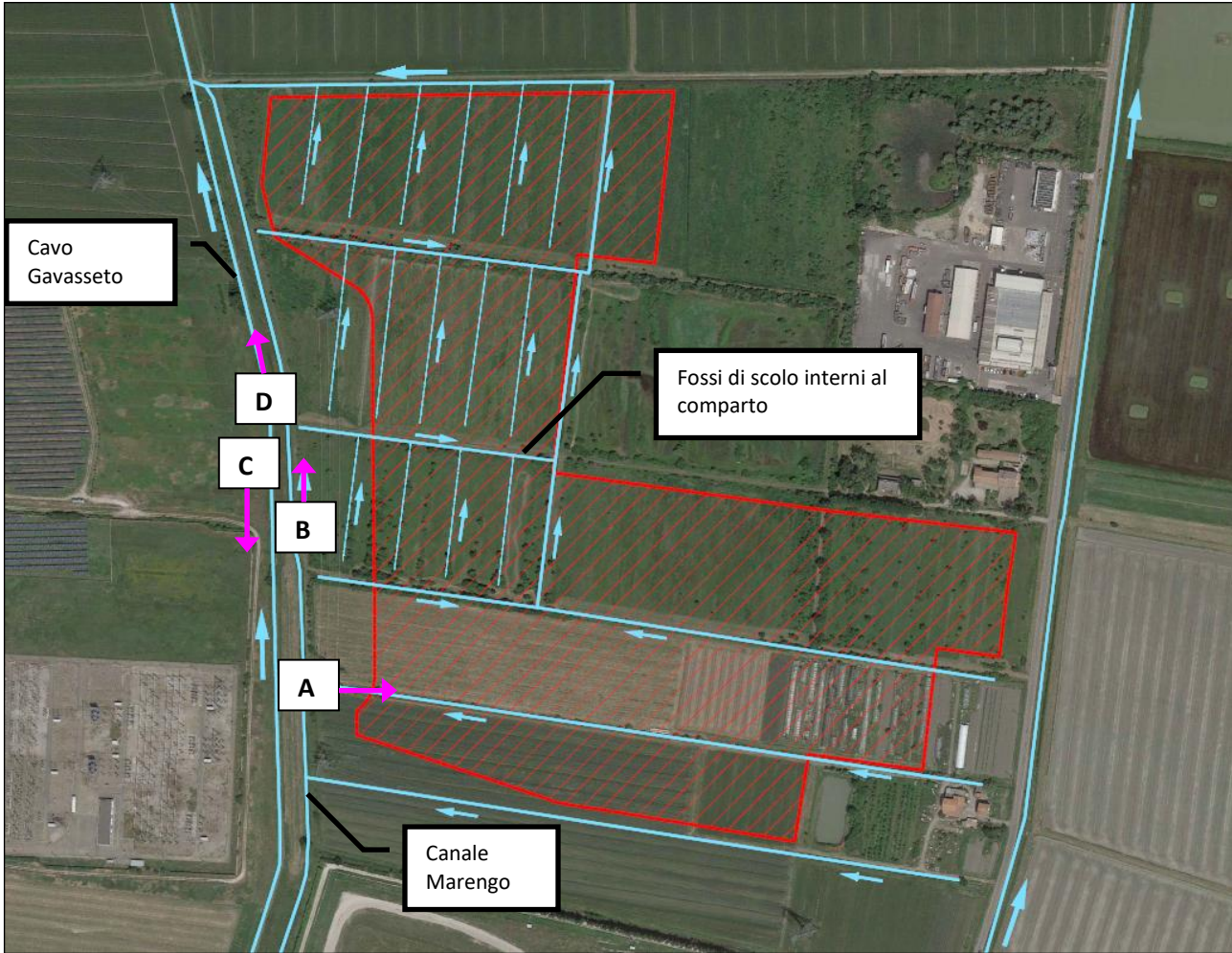
Figura 23. Schema della rete idrografica in prossimità dell'area di intervento Est (condizione attuale). Il recapito finale è rappresentato dal Cavo Gavasseto. Le lettere indicano l'identificativo delle riprese rappresentate nella successiva Figura 24.
