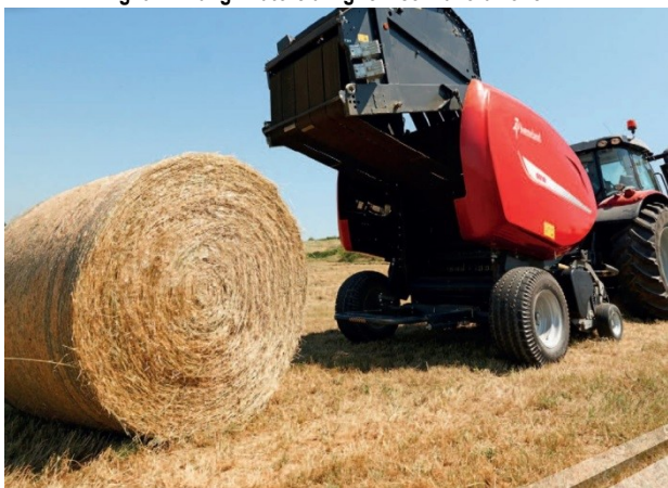
Fig. 6.6 - Rotoimballatrice cilindrica trainata da trattore (2,5 m)
