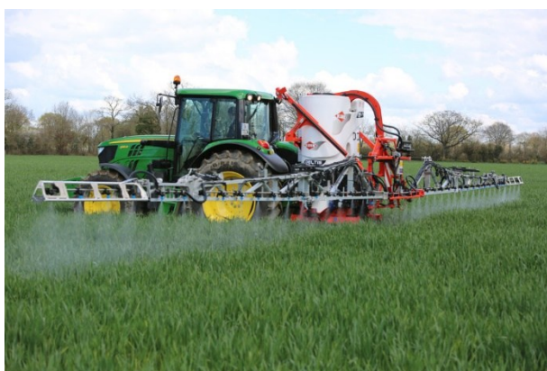
Fig. 6.16 – Botte diserbo pneumatica con barra aperta in azione
