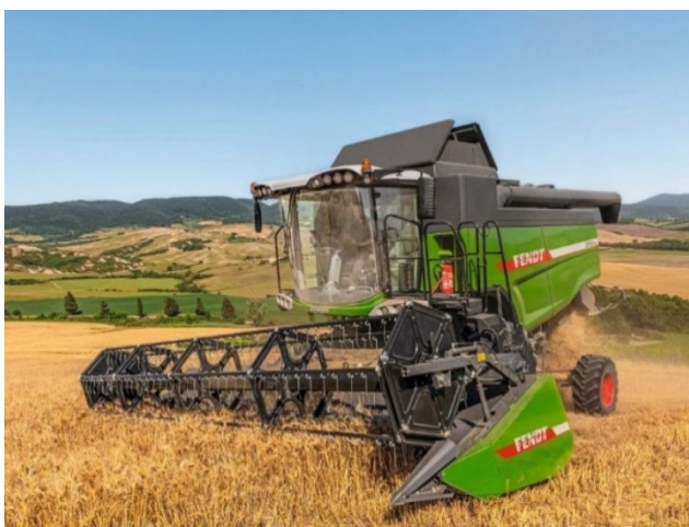
Fig. 6.18 – Mietitrebbia con elevata capacità di lavoro con barra da 6 m
