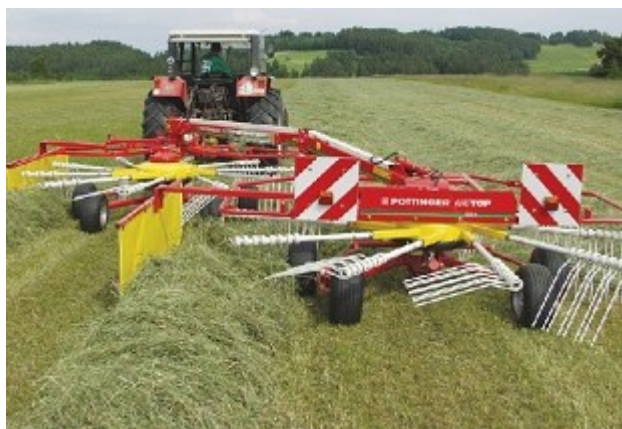
Fig. 6.4 - Ranghinatore a 2 girielli con lavorazione 4 m
