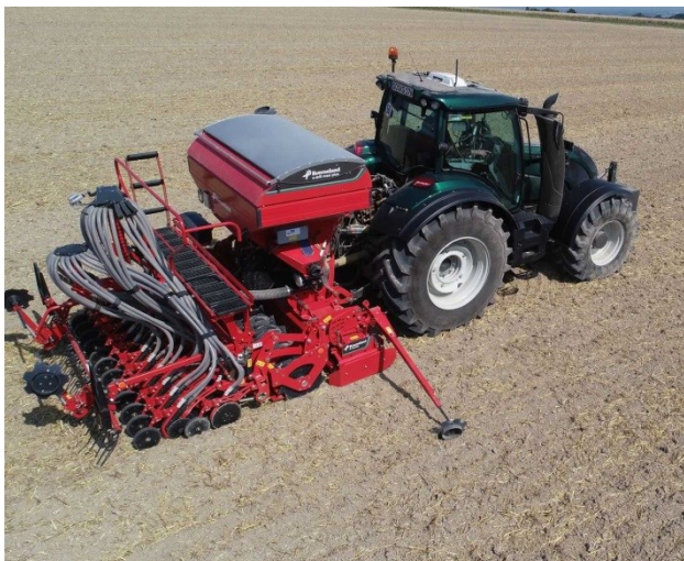
Fig. 6.2- Seminatrice combinata con lavorazione 3,5 m
