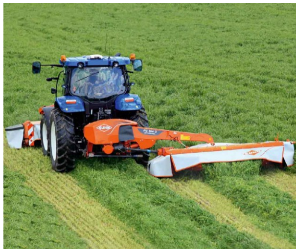
Fig. 6.3 - Falcia condizionatrice combinata con lavorazione 5 m
