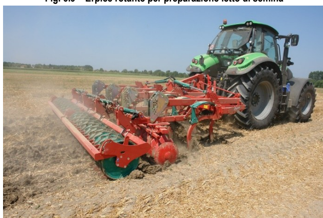
Fig. 6.11 – Attrezzatura combinata per la preparazione del terreno
