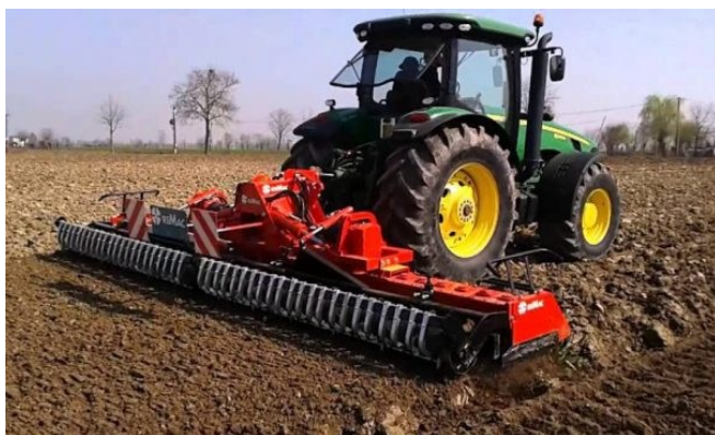
Fig. 6.9 – Erpice rotante per preparazione letto di semina
