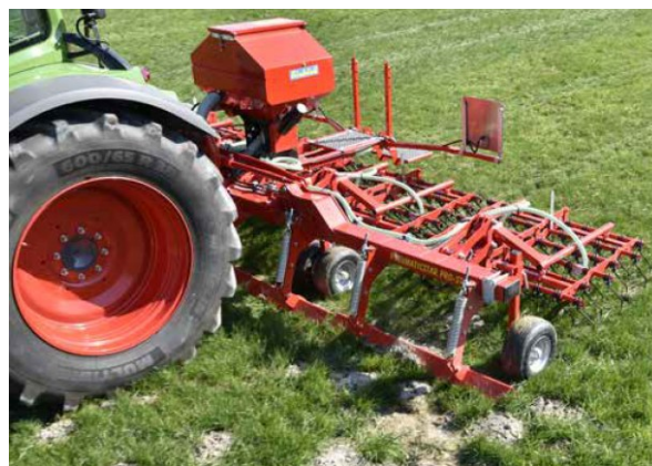
Fig. 6.5 - Erpice strigliatore con lavorazione 5 m
