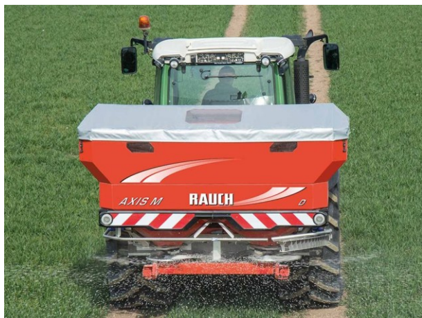
Fig. 6.13 – Spandiconcime a spaglio centrifugo per solido
