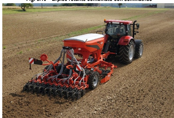
Fig. 6.12 – Attrezzatura combinata per preparazione letto e semina
