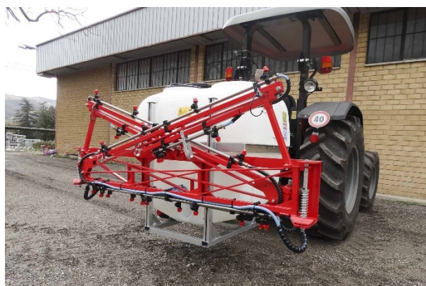
Fig. 6.17 – Botte diserbo pneumatica con barra da 6 m ripiegata
