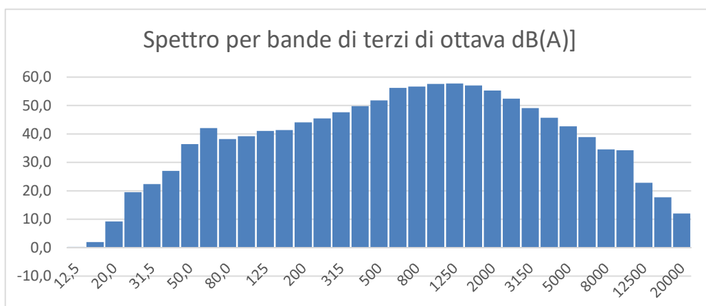
Figura 7-11 – Postazione PM5 - Spettro dei livelli acustici per bande di terzi di ottava [dB(A)]
