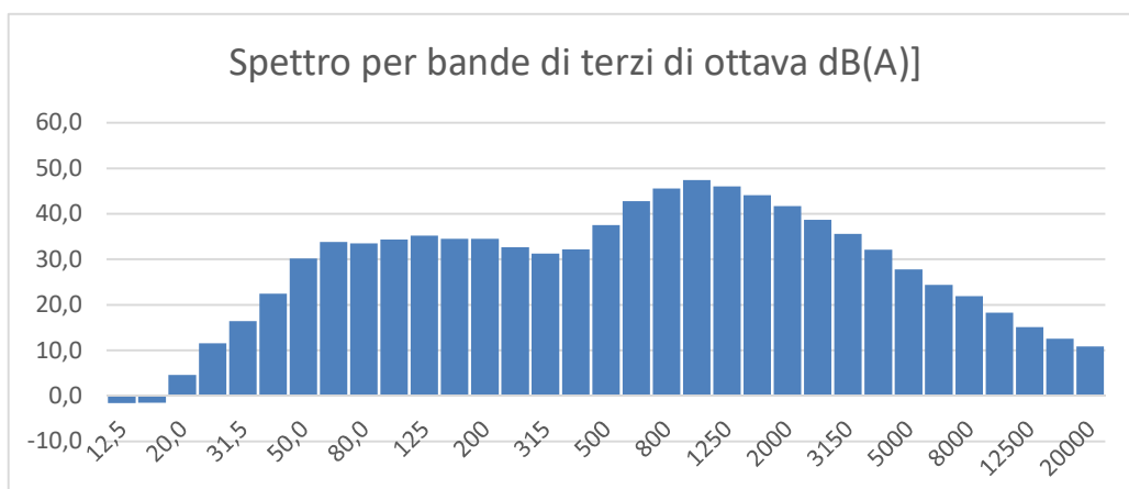
Figura 7-10 – Postazione PM4 - Spettro dei livelli acustici per bande di terzi di ottava [dB(A)]
