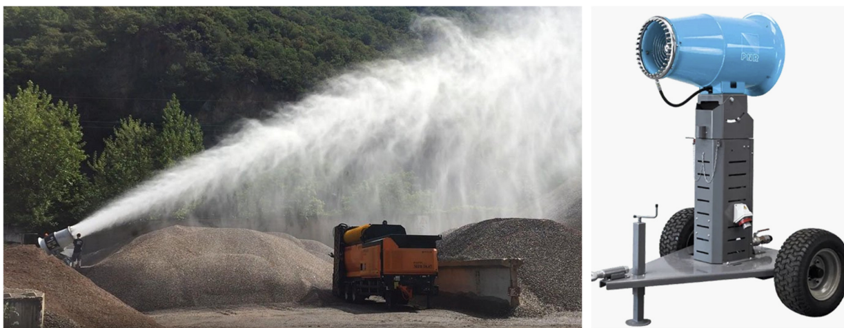
Figura 10-1 – Barrieramento ad acqua mediante fog cannon
