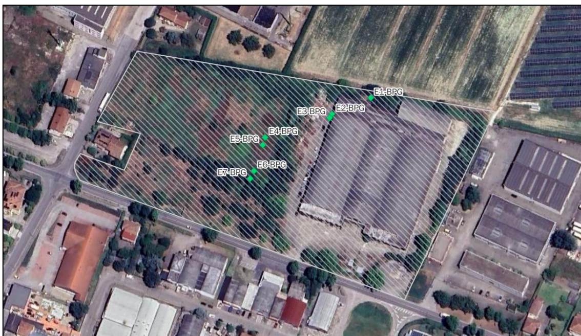
Figura 5: Ortofoto con indicazione del perimetro di progetto e dei camini allo scenario di riferimento per la ditta Italiana Polimeri
