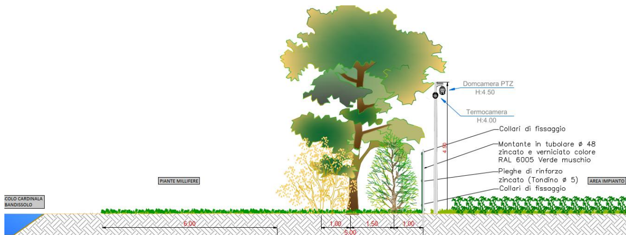
Figura 3-8: Schema fascia perimetrale di 5 m (lati esterni dell'impianto)
