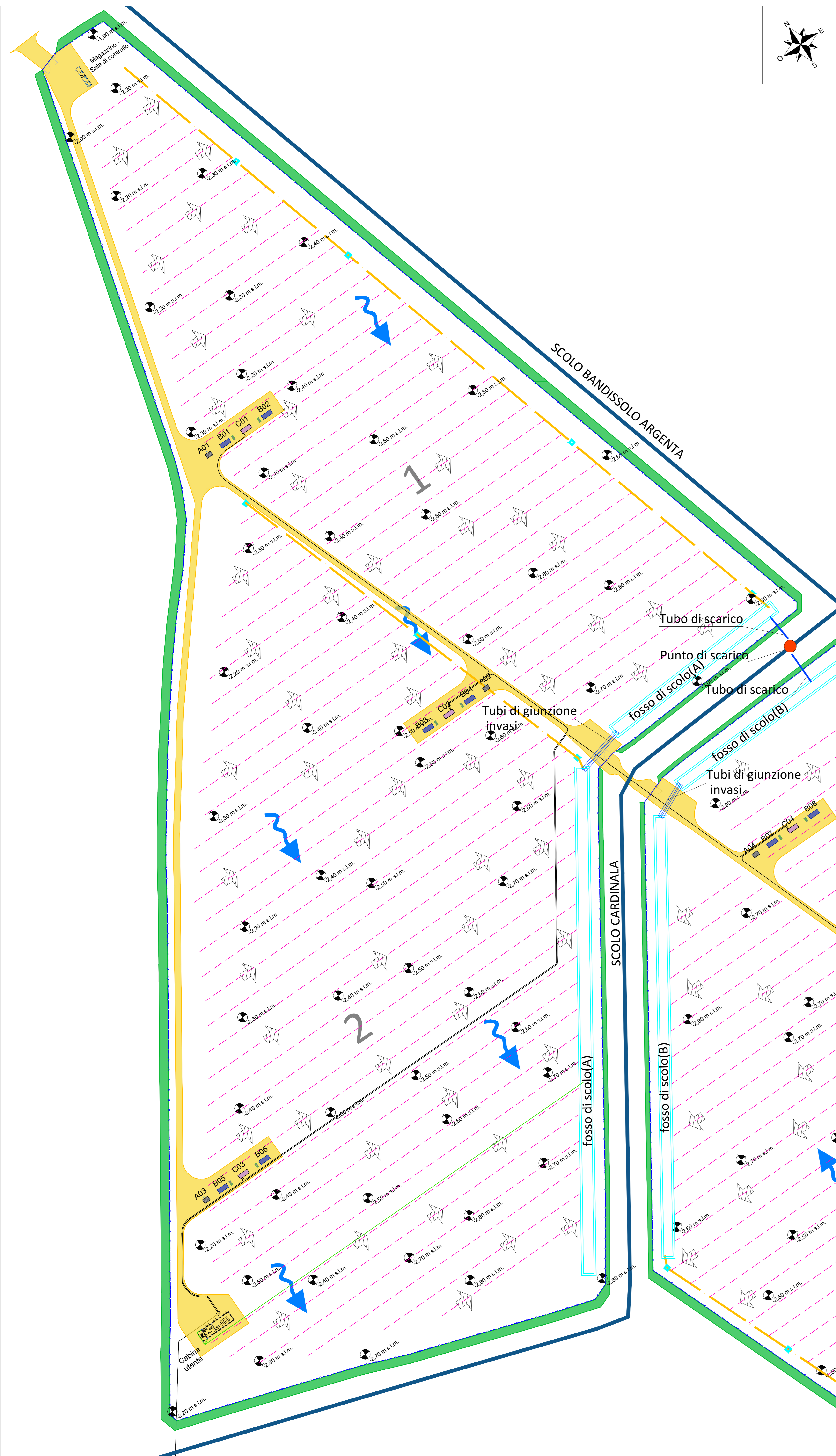
PLANIMETRIA OPERE IDRAULICHE SOTTOAREE 1 e 2 - SCALA 1:1000
