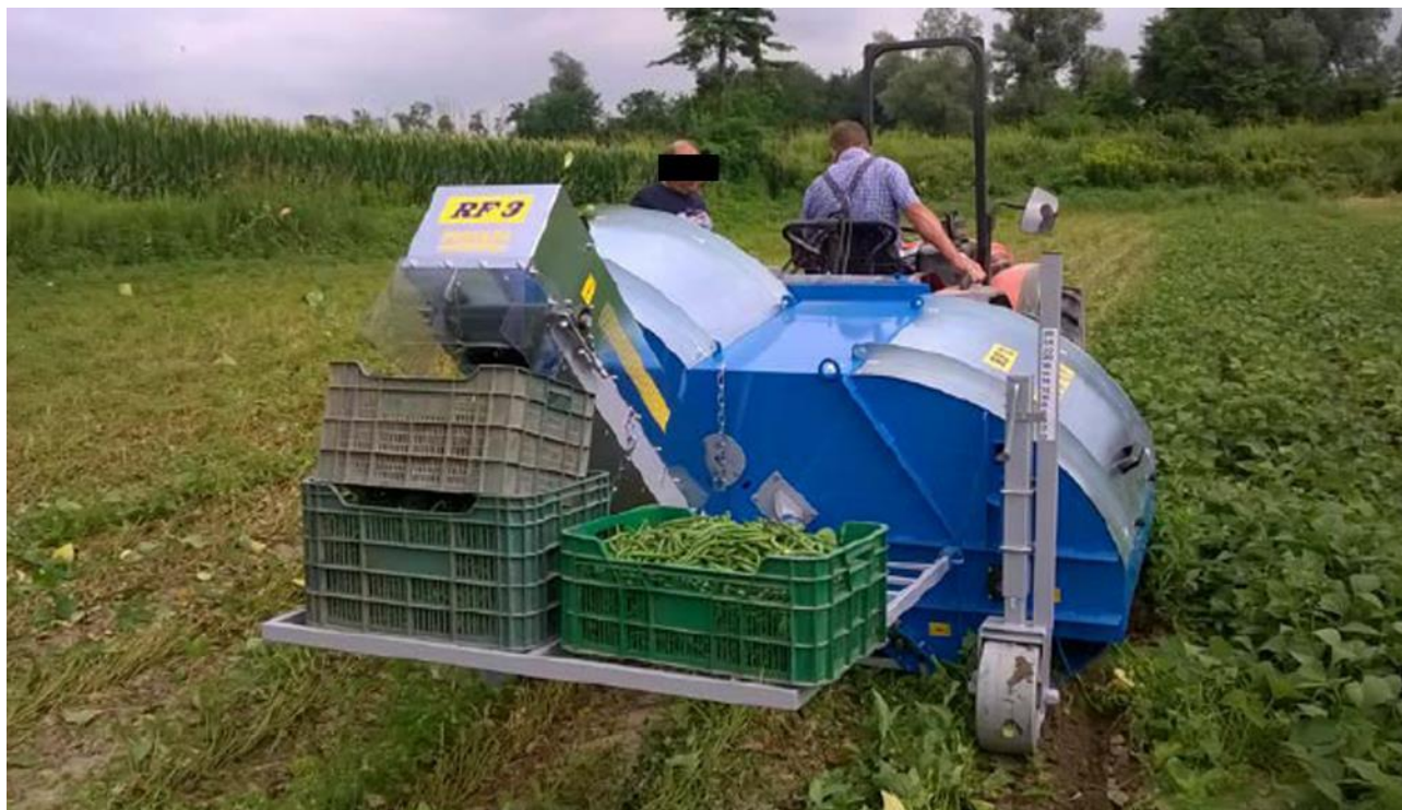
Figura 6-18-Macchina raccoglitrice per fagiolino (non presente in azienda ma compatibile con l'interfila dell'impianto agrivoltaico)
