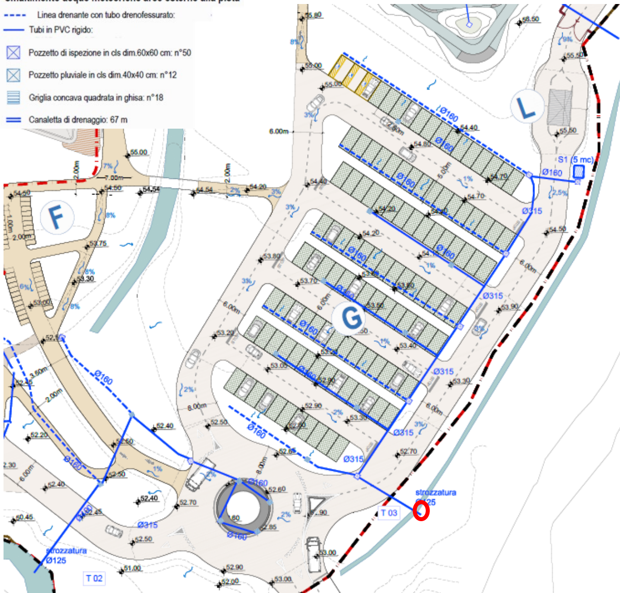
Figura 3 - Sistema di drenaggio dell’area parcheggi (in rosso indicato il punto di immissione nel rio)
