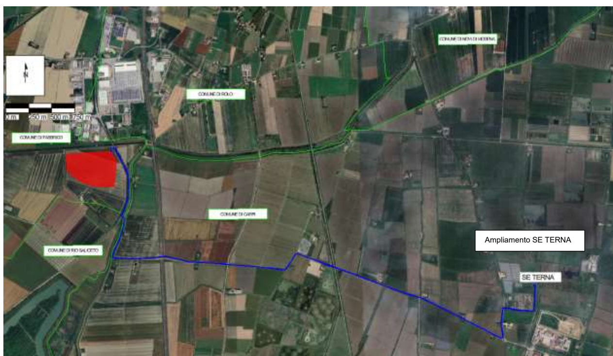
Figura 1 – Sovrapposizione su ortofoto dell'area di impianto (in rosso) e del percorso del cavidotto di connessione alla rete (in blu).
