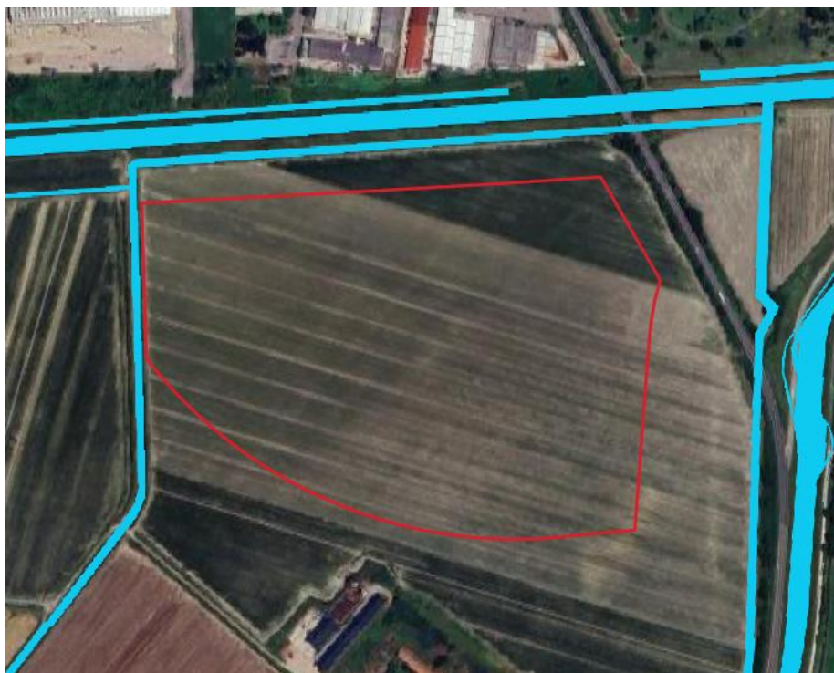
Figura 67 – Inquadramento satellitare dei canali di scolo delle acque accatastati (in blu) rispetto all’area di impianto (in rosso)
