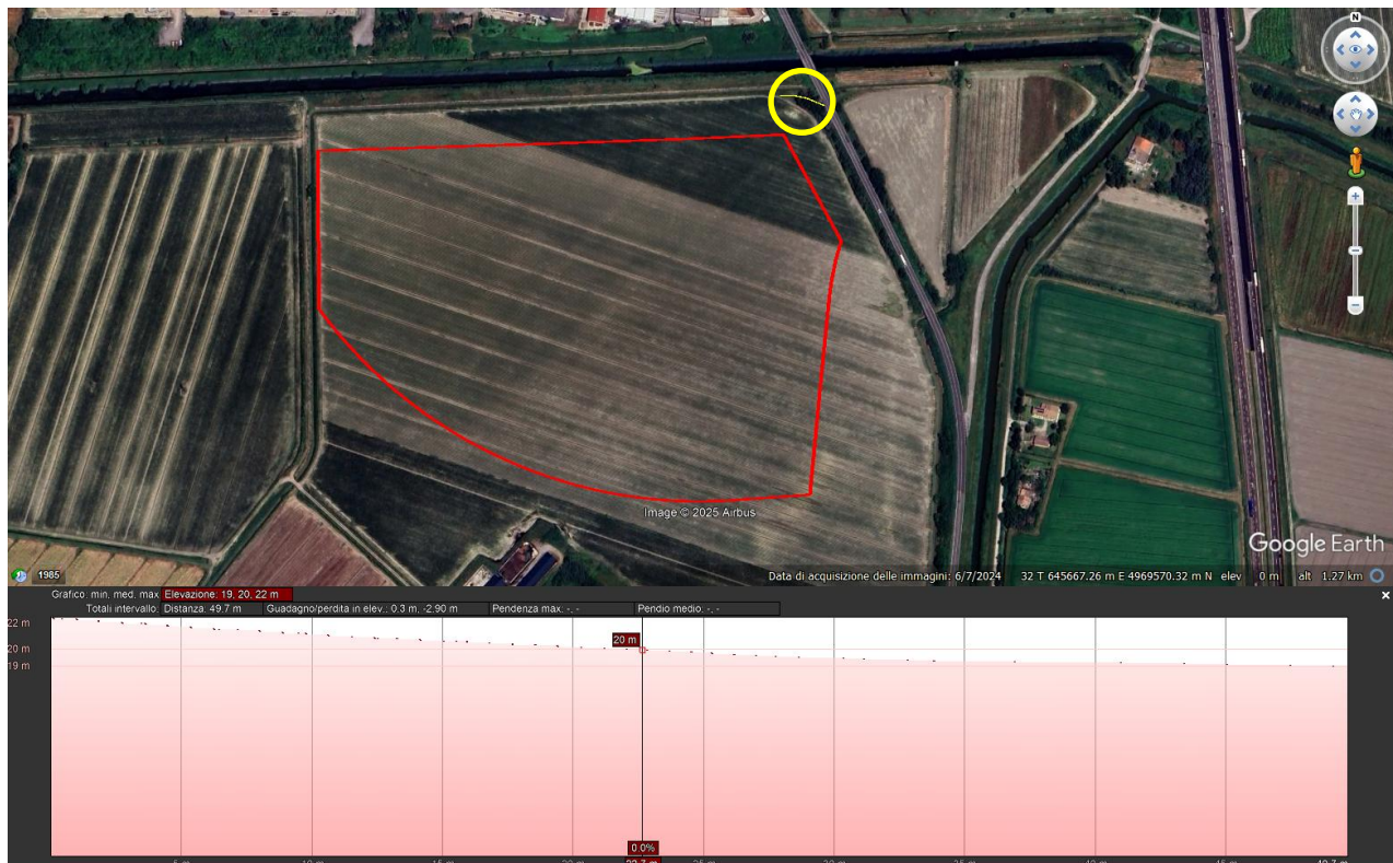
Figura 72 – Profilo di elevazione accesso area
