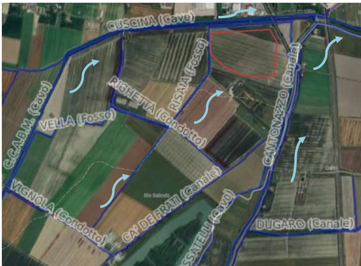
Figura 4 - Sovrapposizione su ortofoto dell'area di impianto (in rosso) e dei canali del Consorzio di Bonifica dell'Emilia Centrale (in blu). (Fonte: Consorzio di Bonifica dell'Emilia Centrale)
