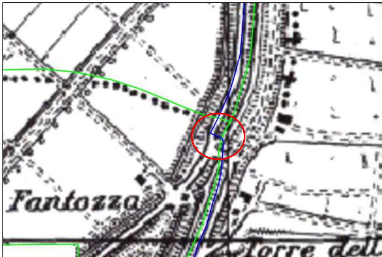
Figura 3: Estratto dell'elaborato "FAB.ENG.TAV.001.01 _Inquadramento territoriale dell'intervento su base IGM.pdf" rappresentante su cartografia IGM la sovrapposizione del cavidotto di connessione (in blu) che interessa l'attraversamento esistente (cerchio in rosso) sul fosso denominato "Fossa Raso e Tresinaro Vecchio". In verde i limiti comunali.
