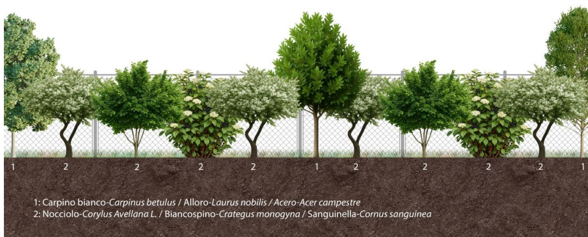
Figura 5.18: Schema sesto di impianto della siepe di mitigazione
