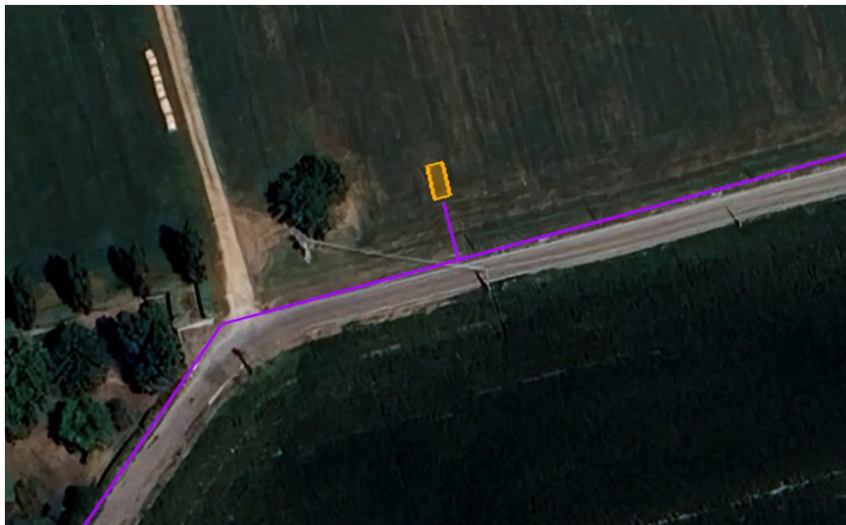
Figura 2.18: Cabina di sezionamento (in arancione) e linea di connessione (in viola), posizione geografica 44.675522°; 10.361423
