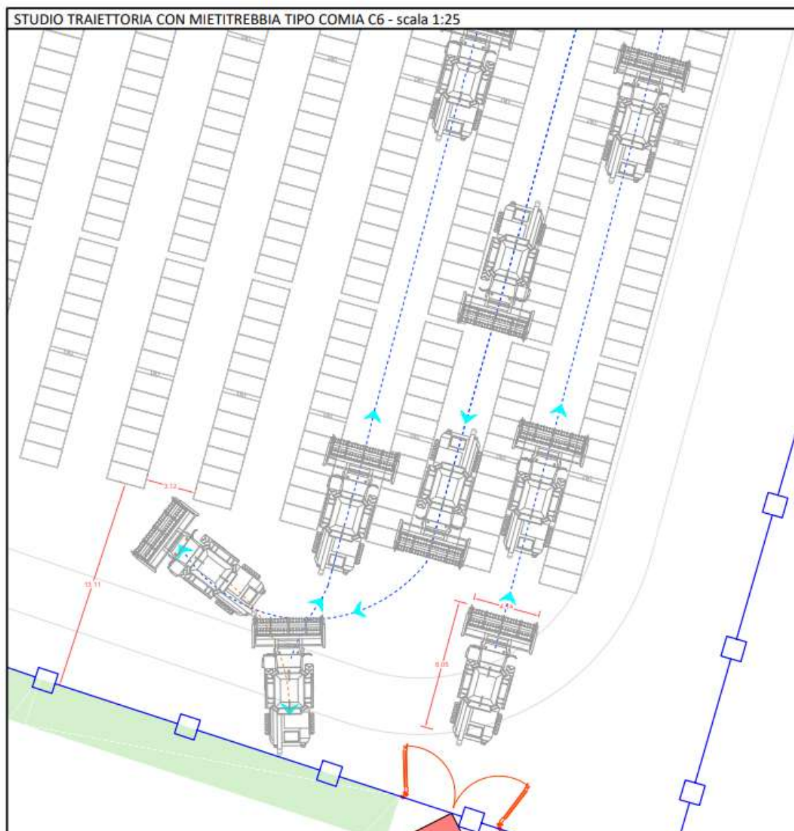
Figura 11 Vista dell'avanzamento tra i pannelli e delle svolte in testata della mietitrebbia (è inoltre visibile in blu l'area recintata ed in rosso lo spazio di ingresso) – estratto dalla tavola 3162_6252_PA_PAUR_T18_Rev0_Movimentazione Mezzi agricoli.
