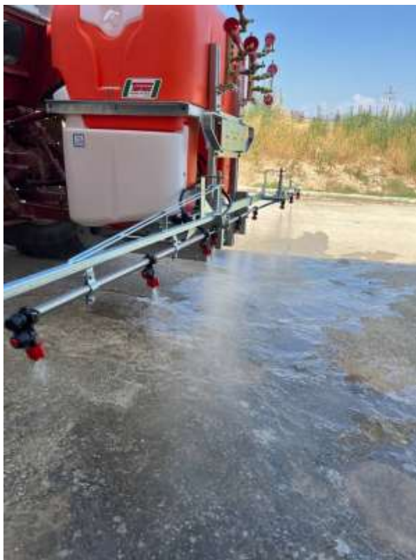
Figura 5 L'irroratrice TOSCANA TO200/51 abbinata alla barra da 4,5 metri utilizzata per effettuare i trattamenti fitosanitari dei seminativi
