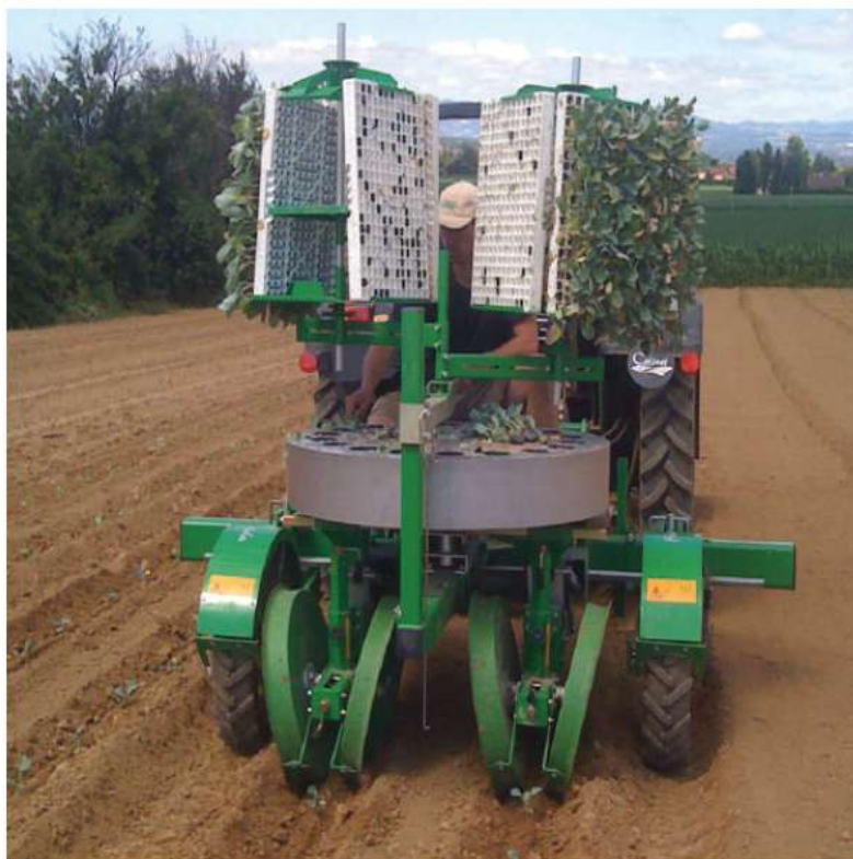
Figura 8 La trapiantatrice Sfoggia F18/C18 utilizzata per la messa a dimora delle piantine di pomodoro da mensa e cavolfiore
